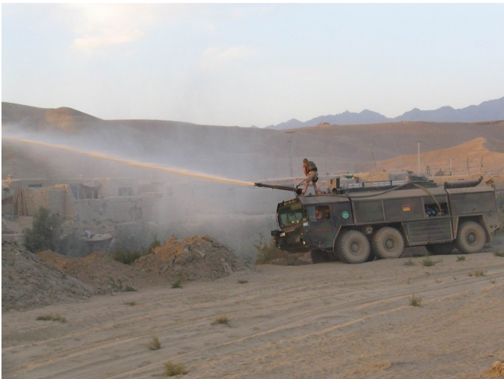
Abb. 64: Ausbringen von B.t.i. am Kabul River, Kabul, Afghanistan, mit Feuerwehrfahrzeug Typ „Faun 3.500 L“: 100 l/min; Fahrgeschwindigkeit 5 km/h (Photo: Faulde, 2004).
