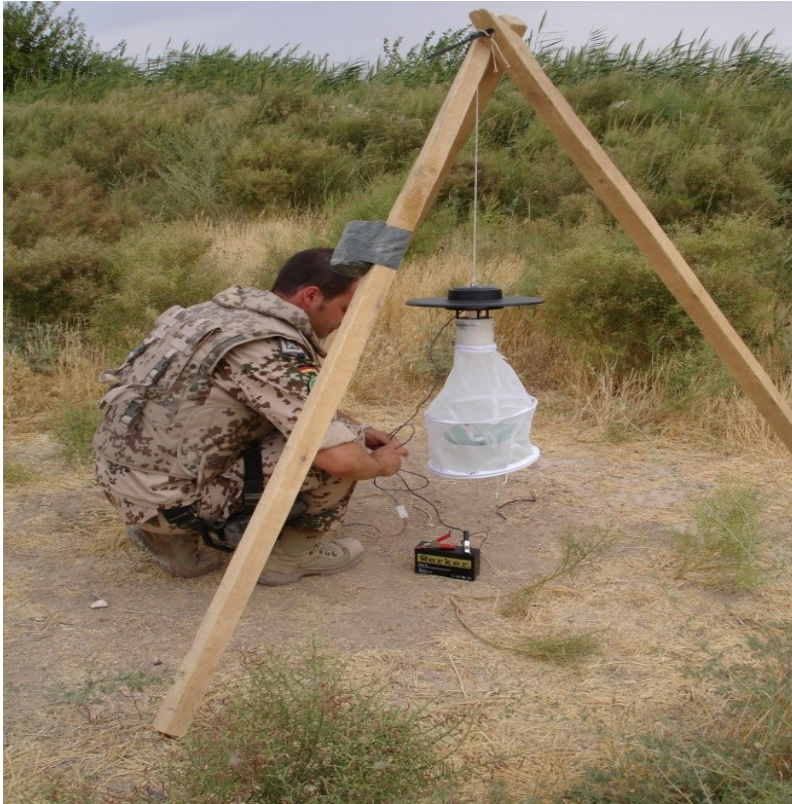
Abb. 11: Aufbau einer CDC – Lichtfalle an Dreibein mit Batterieversorgung in Afghanistan.
