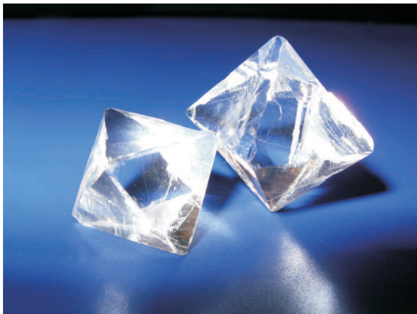
Abbildung 1.1: Calciumfluorid-Einkristalle 1 . Die Spaltflächen der dargestellten oktaedrischen Kristalle sind (111)-Ebenen, die natürlichen Spaltebenen von \text{CaF}_2 .
