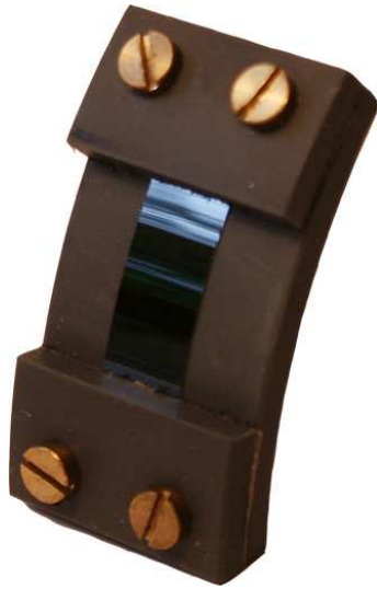
Abbildung 3.5: Der Probenhalter aus PVC, in den die Proben eingespannt werden, um durch Biegung relative Dehnungen bzw. Stauchungen in der implantierten Schicht nahe der Oberfläche zu erzeugen.
