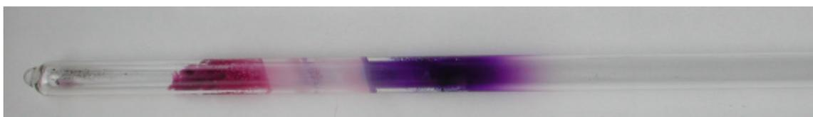
Foto 9.4: Ampulle mit Cobalt(II)-trifluoracetat-tetrahydrat bei 250 °C im kontinuierlich gepumpten Vakuum.
