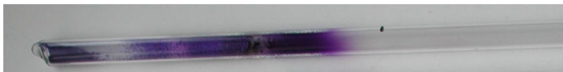
Foto 9.5: Ampulle mit Cobalt(II)-benzoat-trihydrat bei 250 °C im kontinuierlich gepumpten Vakuum.
