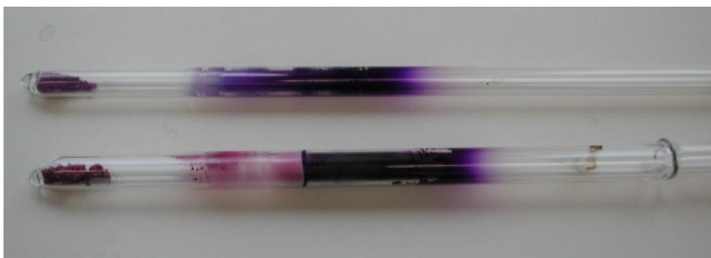
Foto 9.6: Ampulle mit Cobalt(II)-propionat-trihydrat oben bei 150 °C unten bei 220 °C im kontinuierlich gepumpten Vakuum.
