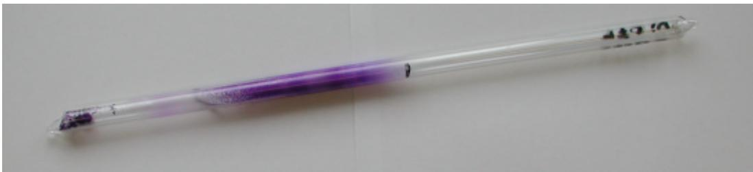
Foto 9.1: Ampulle mit Cobalt(II)-dimethylacetat-trihydrat bei 150 °C im kontinuierlich gepumpten Vakuum.
