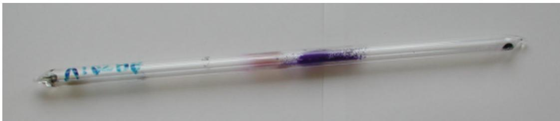
Foto 9.3: Ampulle mit Cobalt(II)-butanoat-dihydrat bei 200 °C im kontinuierlich gepumpten Vakuum.
