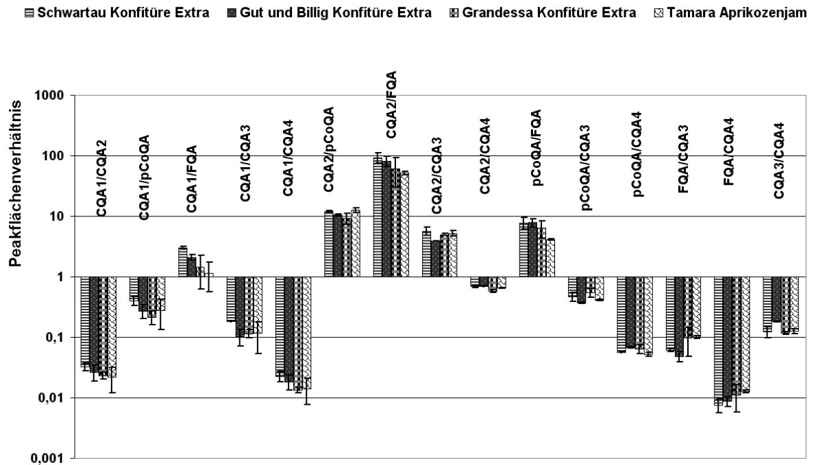
Abbildung 2.4.3-4 Vergleich von Phenolcarbonsäurepeakflächenverhältnissen handelsüblicher Aprikosenkonfitüren
