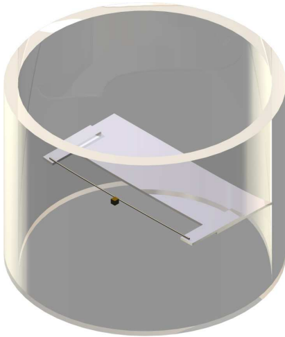
Abbildung 3.12 – Aufbau der selbst hergestellten Phantombehälter und der Halterung am Glasfaden. Der zylindrische Phantombehälter hatte einen Innendurchmesser von 90 mm und eine Höhe von 74 mm. Der Boden und Deckel wurden durch 23 µm Mylar®-Folien gebildet. Der Halter des Quarzglasfadens (20 µm Durchmesser) in U-Form wurde in verschiedenen Abständen vom Boden an die Innenwand des Phantombehälters geklebt. Die Eierschalenstücke wurden an den Quarzglasfaden mit einer speziellen Vorrichtung (siehe [95]) angeklebt.
