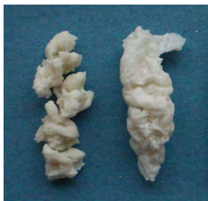
Abb. 4.110 Extrudat der Charge A und B (von l. nach r.) Kartoffelstärke + Weichmachermischung + Tramadol*HCl
