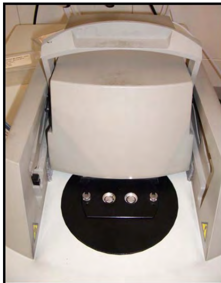
Abb. 3.10: Foto der DSC Pyris 1 (deutlich zu erkennen sind die 2 getrennten Öfen für Probe und Referenz)
