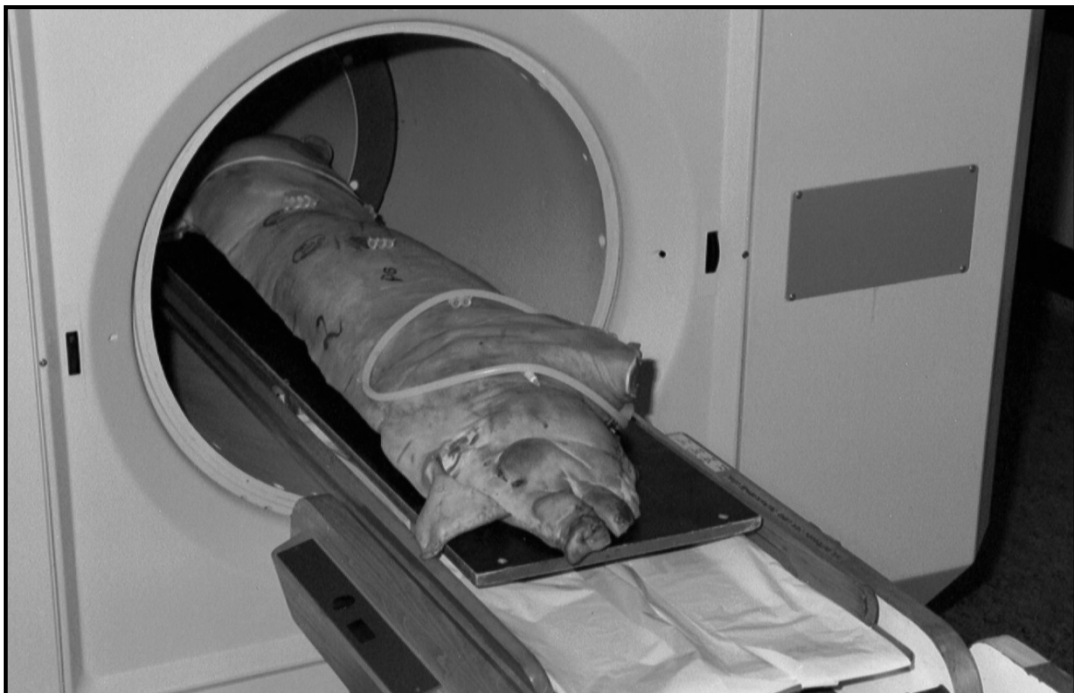
Abb. 5: Linke Schlachtkörperhälfte eines Schweins im Tunnel des Tomographen
