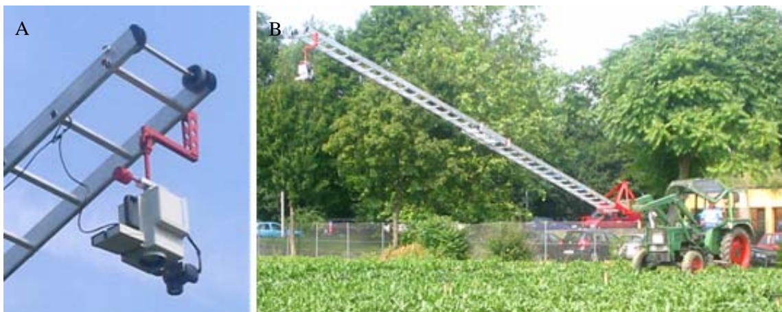
Abb. 2-2 Halterung für eine VARIOSCAN Thermographiekamera, Modell 3021-ST, und eine Digitalkamera am Ende einer Leiter (A), und die Anbringung dieser Kamerahalterung über den Dreipunktbock eines Frontladers an einen Traktor (B) zur orthogonalen Aufnahme von Zuckerrübenparzellen auf dem Versuchsfeld Poppelsdorf im Jahr 2005.
