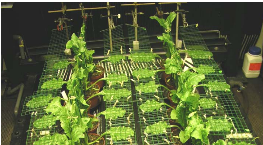
Abb. 2-1 Fixierung von jeweils zwei Blättern einer Zuckerrübenpflanze der Sorte Nematop zur Erfassung des Krankheitsverlaufes bei einer Infektion durch Uromyces betae mit einer Thermo-, einer Chlorophyllfluoreszenz- und einer Videokamera.
