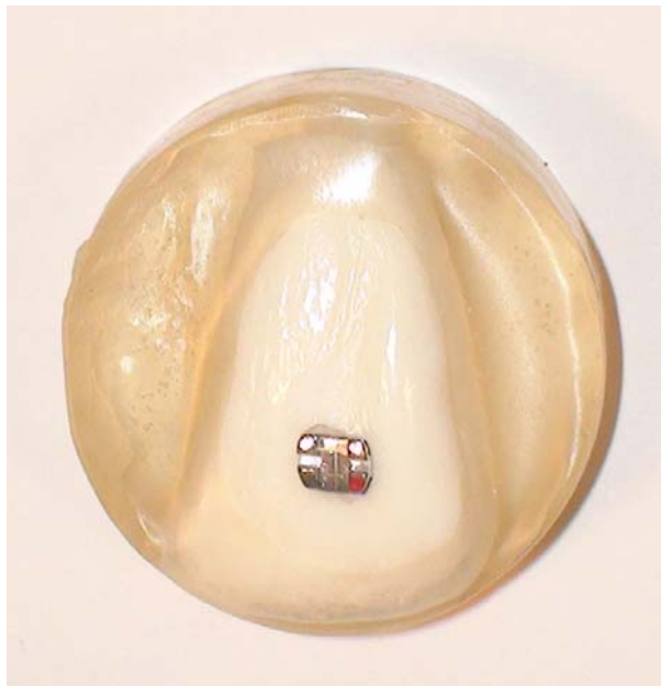
Abbildung 11: Prüfkörper für den Scherversuch des Gesamtverbundes Zahn-Adhäsiv-Bracket: In Kunststoff (Technovit 4004) eingebetteter Zahn mit Bracket.
