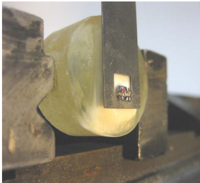
Abbildung 14: In der Universalprüfmaschine fixierter Prüfkörper mit angelegtem Zugscherbügel, der dicht an der Verbundfläche anliegt.
