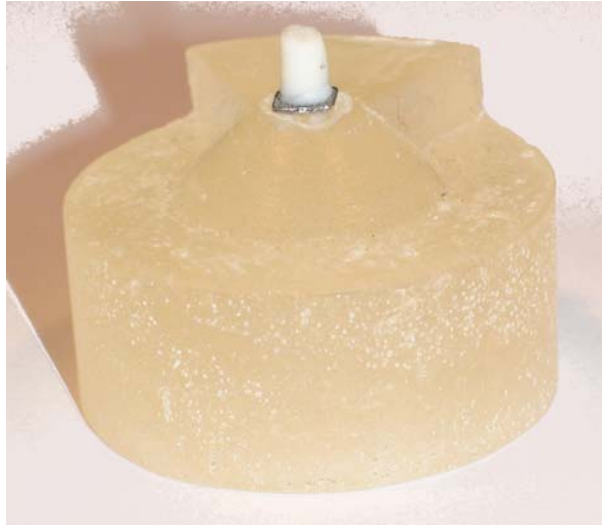
Abbildung 9: Fertiger Prüfkörper für den Scherversuch des Verbundes Bracket-Adhäsiv: auf die Bracketbasis geklebter Adhäsivprüfkörper (Basisklebefläche 7,07 mm 2 ).
