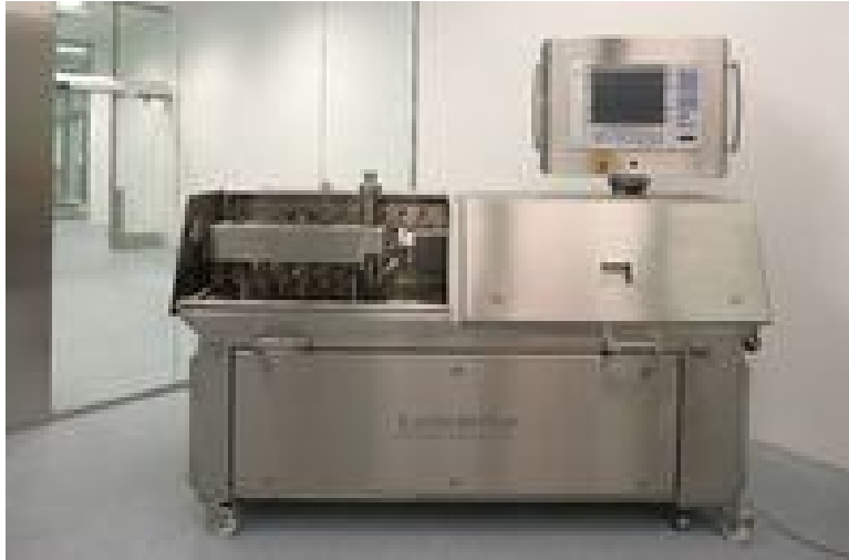
Abb.8: GMP gerechte Ausführung des Zweischnckenextruders Leistritz Typ ZSE 18 HP PH 40 D (Rottendorf Pharma GmbH)
