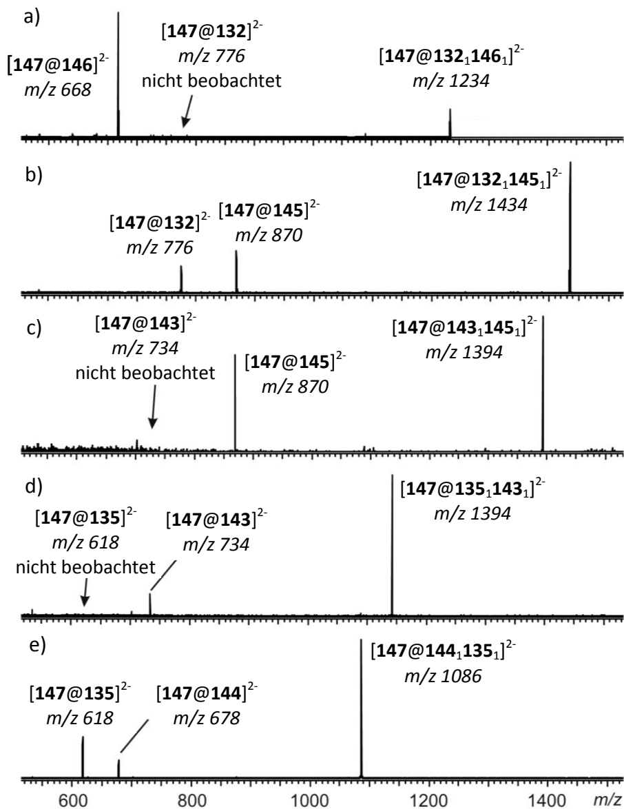
Abb. 5.1: Aufklärung der relativen Bindungsaffinitäten von funktionalisierten Cavitanen zu Indigocarmin mittels CID-Experimenten mit massenselektierten Heterodimer-Indigocarmin-Komplexen: a) [147@132,146]^{2-} , b) [147@132,145]^{2-} , c) [147@143,145]^{2-} , d) [147@135,143]^{2-} , e) [147@144,135]^{2-} ; [119]
