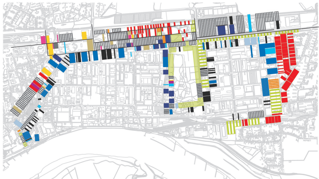
Abb. 38: Darstellung der Flächennutzungen als Abwicklung der Straßenseiten [Häusler, 2008] Alle Flächeninformationen zur Parzellengröße oder Grundstückszuschnitt bleiben unberücksichtigt und nur die rein-binäre Information der Nutzungsexistenz wird in ihrer Position an der Straßenseite aufgetragen.
