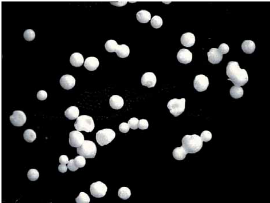
Abb. 4-28 Beispielpräparat mit Mehrlingen und Agglomeraten, Zusammensetzung der Ausgangslösung: Trehalose 7,5 %, Na-Hyaluronat 0,1 %
