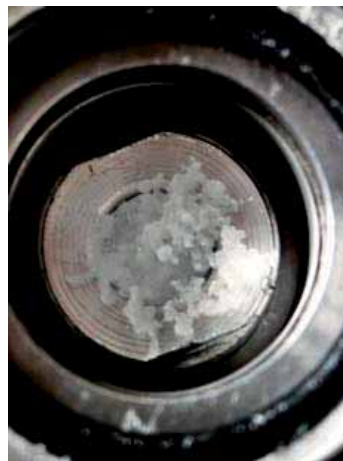
Sprühvorrichtung mit Membranfilter: Düse vereist
