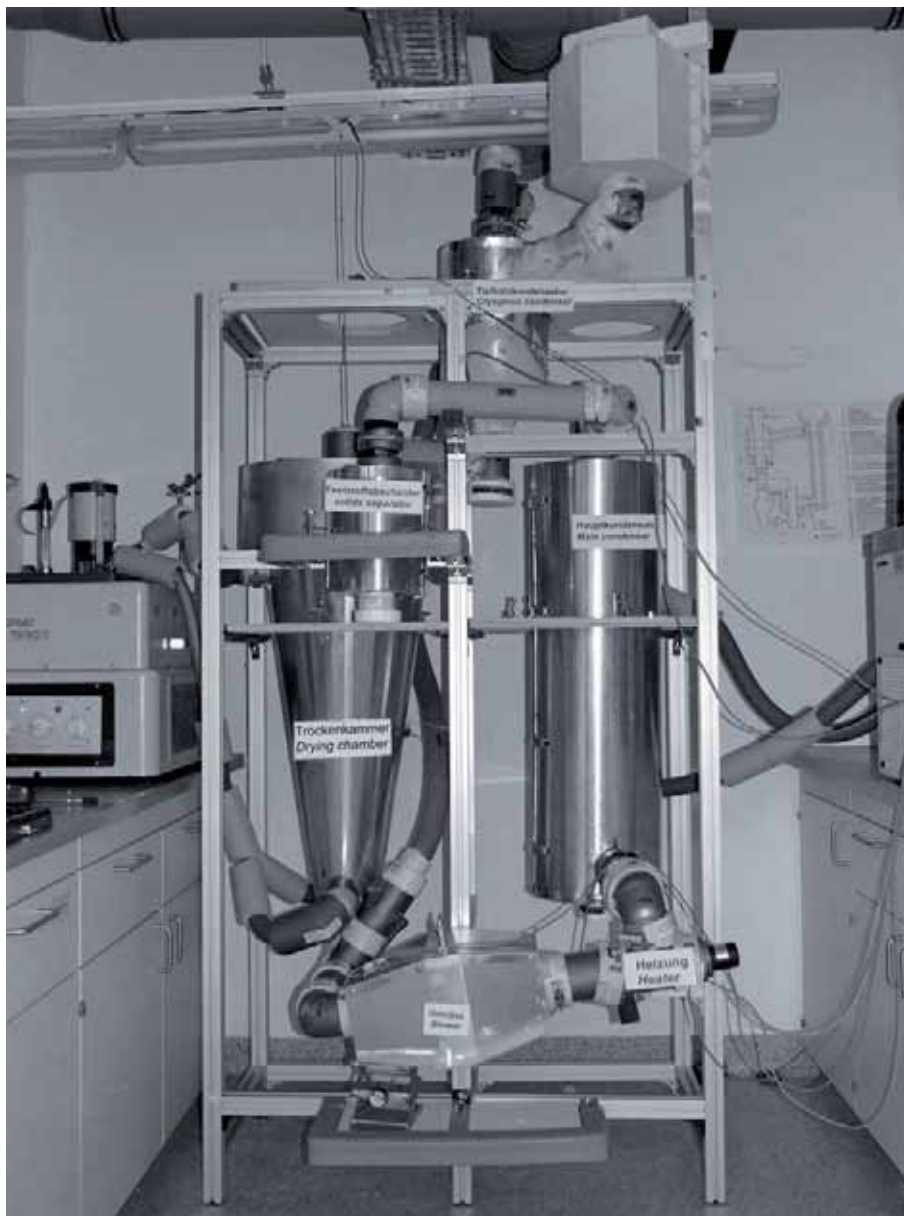
Abb. 5-1 Versuchsanlage zur atmosphärischen Gegenstrom-Tropfenstrahl Gefriertrocknung (Atmospheric Counter-Current Lyophilization, ACD-Lyophilization)
