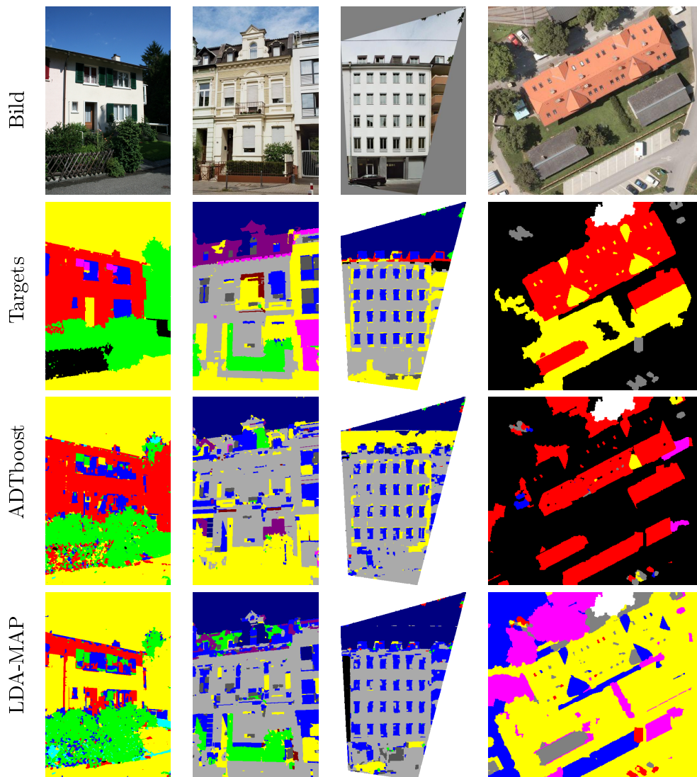
Abbildung 4.22.: Visueller Vergleich zwischen den Targets der Regionen und den Klassifikationsergebnissen für die Beispielbilder aus Abb. 2.14, die wir noch einmal in der obersten Zeile zeigen. Darunter visualisieren wir erneut die Targets der Regionen (wie in Abb. 3.9). Die beiden unteren Zeilen sind neu, darin präsentieren wir die Klassifikationsergebnisse mit ADTboost sowie mit der MAP-Klassifikation im LDA-Unterraum. Vertikal gesehen bedeuten gleiche Farben auch gleiche Klassen. Weiße Pixel bedeuten dabei, dass in diesem Bildbereich keine stabilen Regionen segmentiert und daher auch nicht klassifiziert wurden. Schwarz sind alle Pixel, die als stabile Region in nicht annotierten Bereichen segmentiert wurden, d. h. sie gehören zur Klasse background . In den terrestrischen Aufnahmen wird Vegetation grün, die Fenster blau, die Restklasse gelb dargestellt, in der linken Spalte bedeutet rot Gebäude, in der Mitte grau Fassade. In den Luftbildern haben wir die Dächer rot visualisiert.
