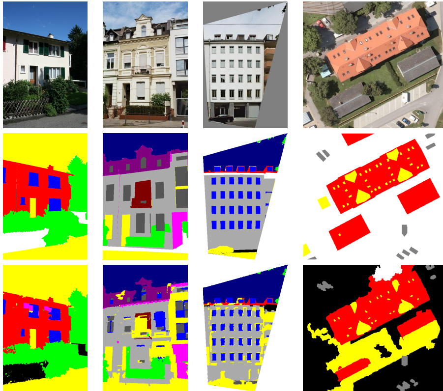
Abbildung 3.9.: Visueller Vergleich zwischen Annotation und Targets der Regionen für Beispielbilder aus Abb. 2.14. In der obersten Zeile zeigen wir wieder die vier Bilder, darunter die Visualisierung der Annotationen dieser Bilder. In der untersten Zeile visualisieren wir die Targets der segmentierten Regionen. Vertikal gesehen bedeuten gleiche Farben auch gleiche Klassen. Weiße Pixel bedeuten dabei, dass dieser Bildbereich nicht annotiert wurde (mittlere Zeile) bzw. dass dort keine stabilen Regionen segmentiert wurden (untere Zeile). Schwarz sind alle Pixel, die zwar als stabile Region segmentiert wurden, zu denen wir aber keine passende Annotation finden können. Pixel von Regionen der zusätzlichen Klasse others stellen wir in allen Bildern gelb dar. Bei allen anderen Farben gibt es keine einheitliche Farbgebung bei allen vier Datensätzen. In der linken Spalte zeigen wir das eine Beispielbild aus dem Benchmark-Datensatz terra-1 . Da haben wir bei den Annotationen und bei den Targets die Gebäudepixel rot eingefärbt, die Vegetation grün und die Fenster blau. Die kleinen magenta-farbenen Regionen stellen Gebäudebereiche dar, die sowohl mit einer Fensterannotation überlappen als auch nicht. Diese Pixel kennzeichnen die Klasse building-mixture . In der rechten Spalte zeigen wir einen Luftbildausschnitt, in dem die vier Klassen background , others (gelb), roof (rot) und car (grau) erkennbar sind. Da wir hier keine Straßen oder Vegetation annotiert haben, kennzeichnen die Regionen der Klasse others vor allem zwei Bereiche: kleinere Dachstrukturen wie Gauben und Fenster sowie Mixturen, die durch die Verschmelzung von Dachregionen mit ihrer Umgebung entstanden sind. In den beiden mittleren Spalten müssen diverse Klassen visualisiert werden. Hier ist vor allem vorzuheben, dass die hellgrauen Pixel zur Klasse facade gehören, die dunkelgrauen Annotationen stellen Fensterscheiben dar und verdecken oft die blau markierten Fenster.
