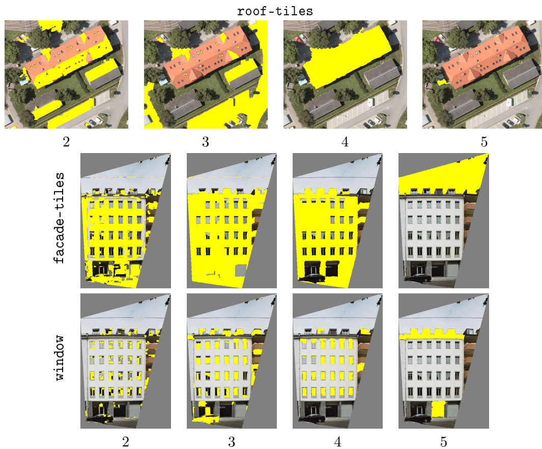
Abbildung 4.20.: Klassifikationsergebnisse (in gelb) von ADTboost in vier verschiedenen Referenz-Maßstabsebenen \sigma_m bzgl. der Klassen roof-tiles im Luftbild-Datensatz aerial (oben) sowie den Klassen facade-tiles (Mitte) und window (unten) im entzerrten Fassaden-Datensatz terra-3 .
