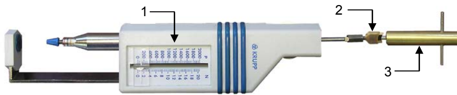
1: Kraftskala mit 1,5 N Abzugskraft, 2: Primär- und Sekundärteleskop, 3: Abzugshilfe
