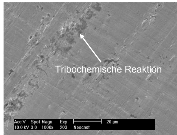
Abbildung 27: Oberflächenzerrüttung und tribochemische Reaktion an einem Primärteleskop
