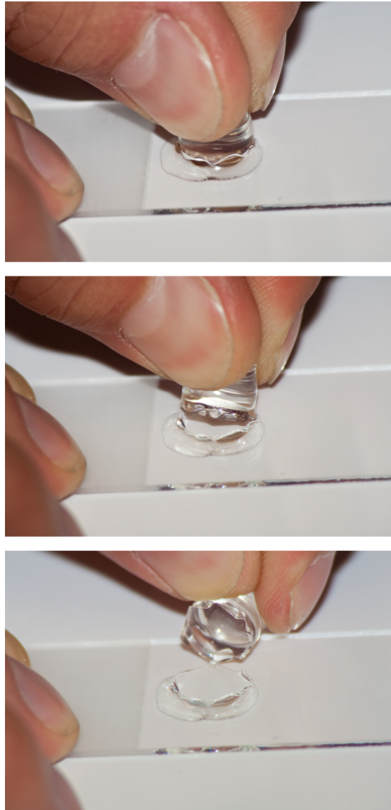
Abbildung 3.14: Abnehmen des Silikonkautschukstempels von der ausgehärteten Kleberfolie. Nach der Behandlung mit UV-Licht, wird der mikrostrukturierte Stempel aus Silikonkautschuk von der ausgehärteten Kleberfolie abgelöst.
