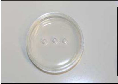
Abbildung 10: Funktionsbereites Agarosegel mit Vertiefungen zum Einfüllen der Chemattraktoren bzw. der Negativkontrolle. (links: Chemoattraktor, Mitte: Zellsuspension, rechts: IMDM-Negativkontrolle)
