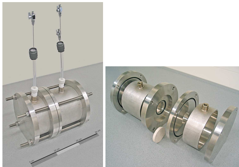
Abb. 4.2: Diffusionszellen aus V5A-Stahl für Versuche mit flüchtigen Substanzen.
