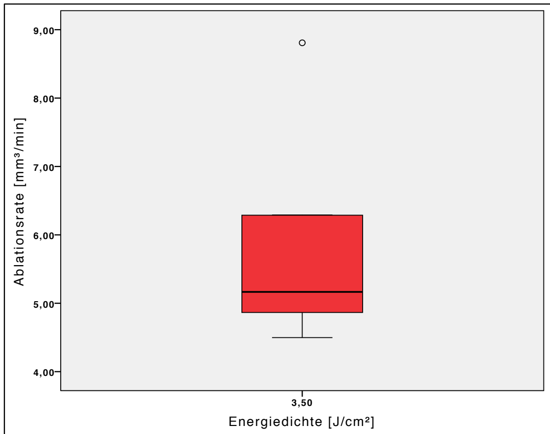
Abb. 16: Darstellung der probekörperabhängigen Streuung der Kavitärentiefe für Kompakta. Der Kreis markiert einen Wert, der das 1,5-fache des Interquartilsabstands überschreitet. Der Medianwert liegt bei etwa 5,2 mm 3 /min, die Standardabweichung liegt bei etwa 1,5 %
