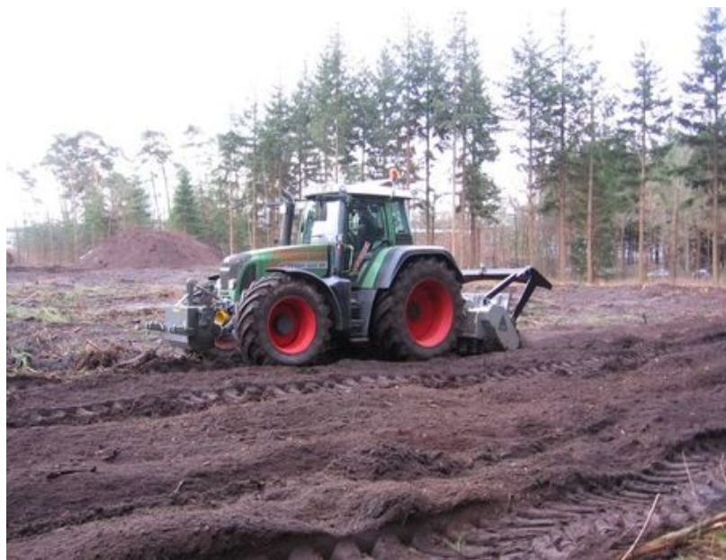
Abbildung 2-7: Forstfräse im Einsatz (Bildquelle: STÜHMER, 2012)
