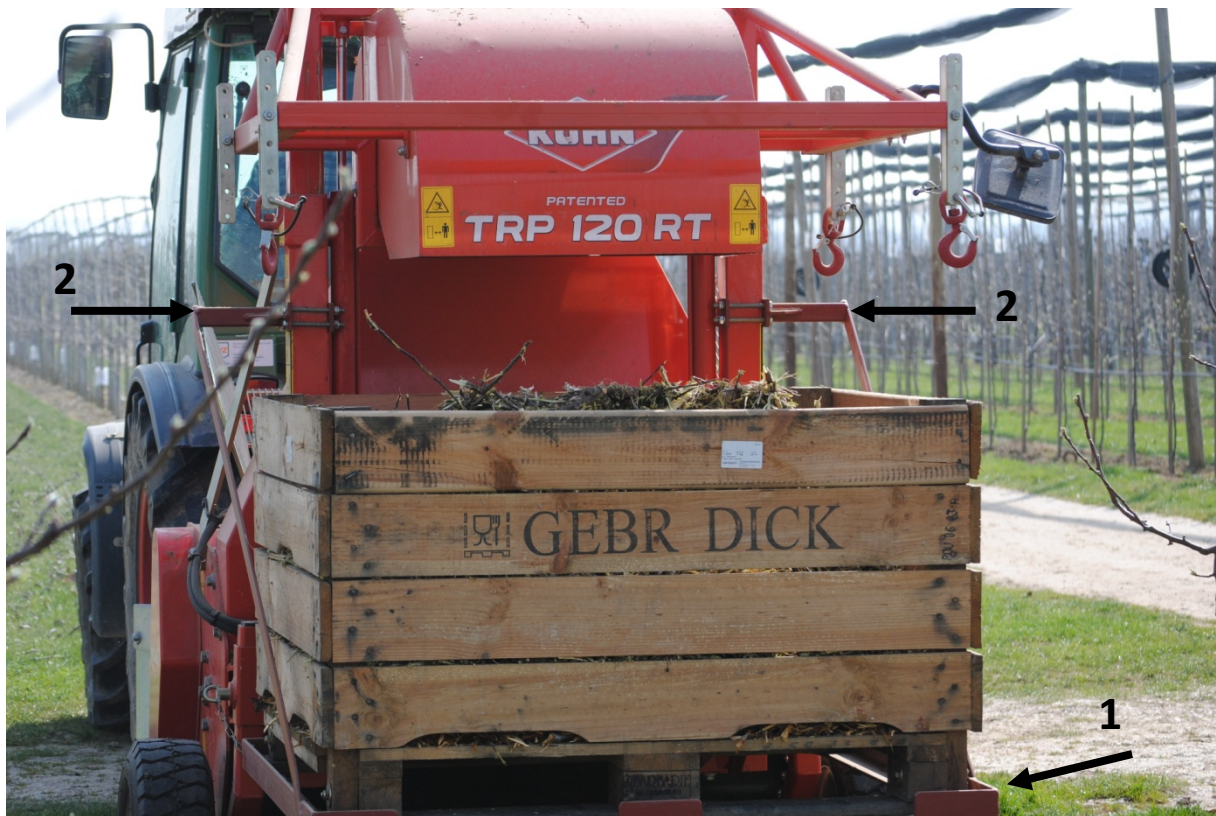
Abbildung 4-1: Modifizierte Bunkereinrichtung für Großkisten des Kuhn-Schnittholzsammlers (Bildquelle: AUMÜLLER GRUBER, 2012); 1: Großkistenaufnahme; 2: Streben
