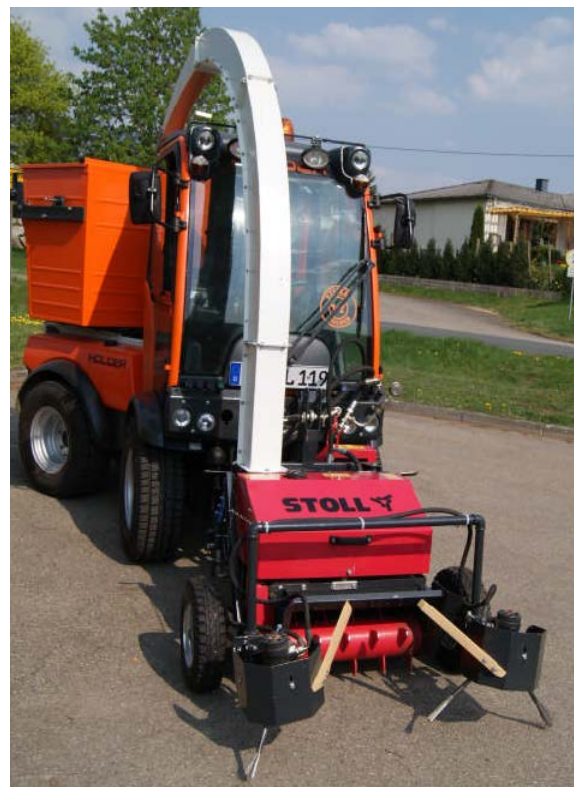
Abbildung 5-1: Rebholzhäcksler Winnicut der Firma Stoll (Bildquelle: STOLL, 2012)
