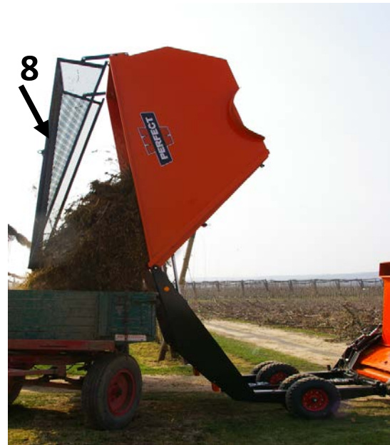
Abbildung 3-5: Perfect Mäh-Lade Wagen beim Entladevorgang; 8: Lochblech
