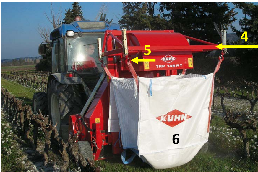
Abbildung 3-3: Bunkervorrichtung vom Schnittholzsammler Kuhn TRP 120 RT H (Bildquelle: TERRA, 2012); 4: Stahlrahmen; 5: Haken; 6: BigBag
