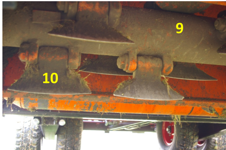
Abbildung 3-6: Schlegelrotor mit 2,2 kg Universalschlägeln des Perfect Mäh-Lade Wagen; 9: Rotorwelle; 10: Schlegel
