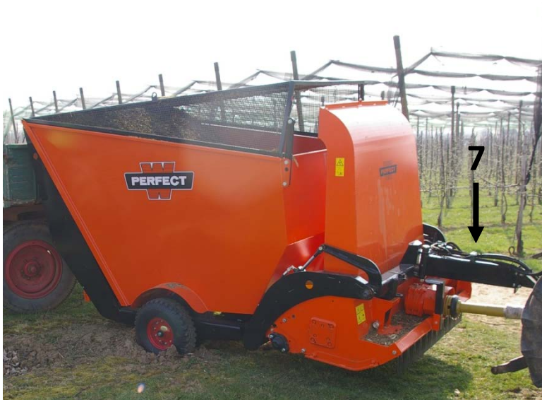
Abbildung 3-4: Perfect Mäh-Lade Wagen; 7: hydraulische Schwenkdeichsel
