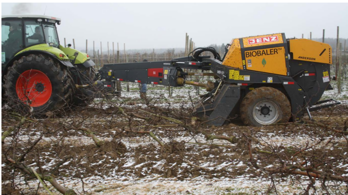
Abbildung 3-13: Aufnahme der gerodeten Obstbäume mit dem BioBaler BW 55
