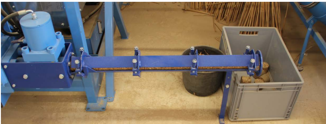
Abbildung 3-18: Standardabkühlstrecke an Brikettierung BrikStar C
