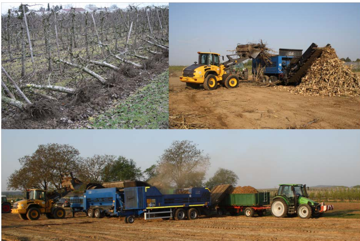
Abbildung 3-12: Weiterverarbeitungskette der gerodeten Obstbäume; oben links: gerodete Birnenbäume, oben rechts: Zerkleinerung mit langsam laufenden Schredder, unten: Siebung und Feinzerkleinerung
