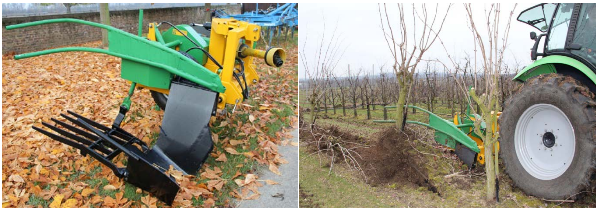
Abbildung 2-9: links: Rodepflug RB 60 Klein-Altendorf (Stand 2012); rechts: Rodeflug bei der Rodung
