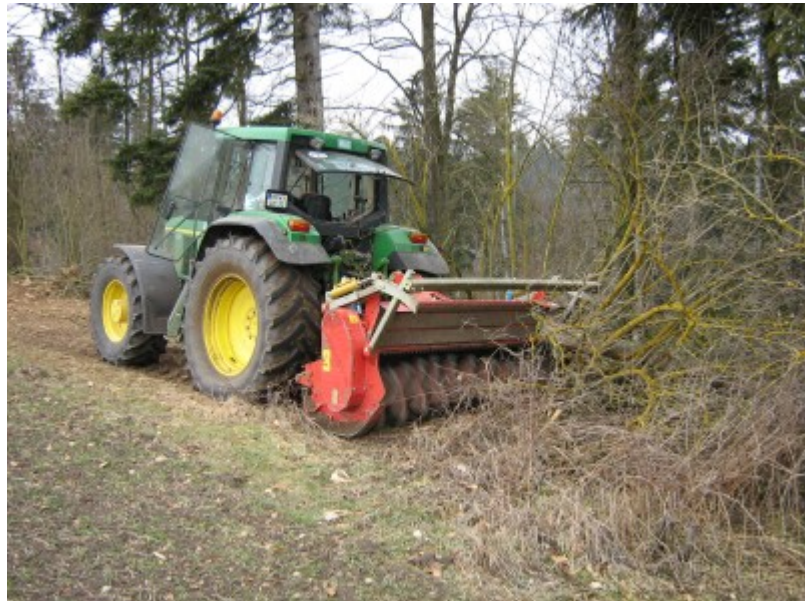
Abbildung 2-6: Forstmulcher im Einsatz (Bildquelle: WEISSER, 2012)
