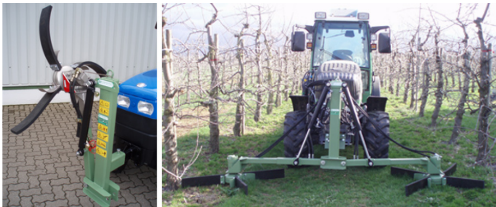
Abbildung 2-2: Reihenputzer zum Entfernen von Schnittholz aus der Baumreihe (Bildquelle: OBSTWEIN-TECHNIK, 2012)
