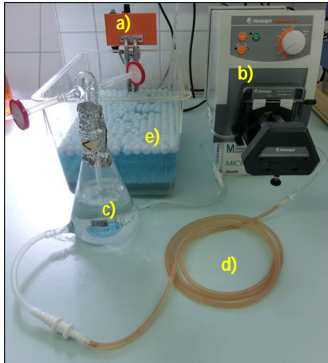
Abbildung 16: Generierung und Animpfen von Biofilmen im geschlossenen Kreislauf
