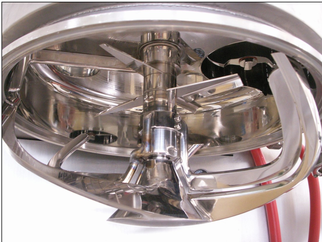
Abb. 6.3.2: Rührelemente (Abstreifer, Zerhacker, Rührer, Austragsabstreifer) im Easy Flow
