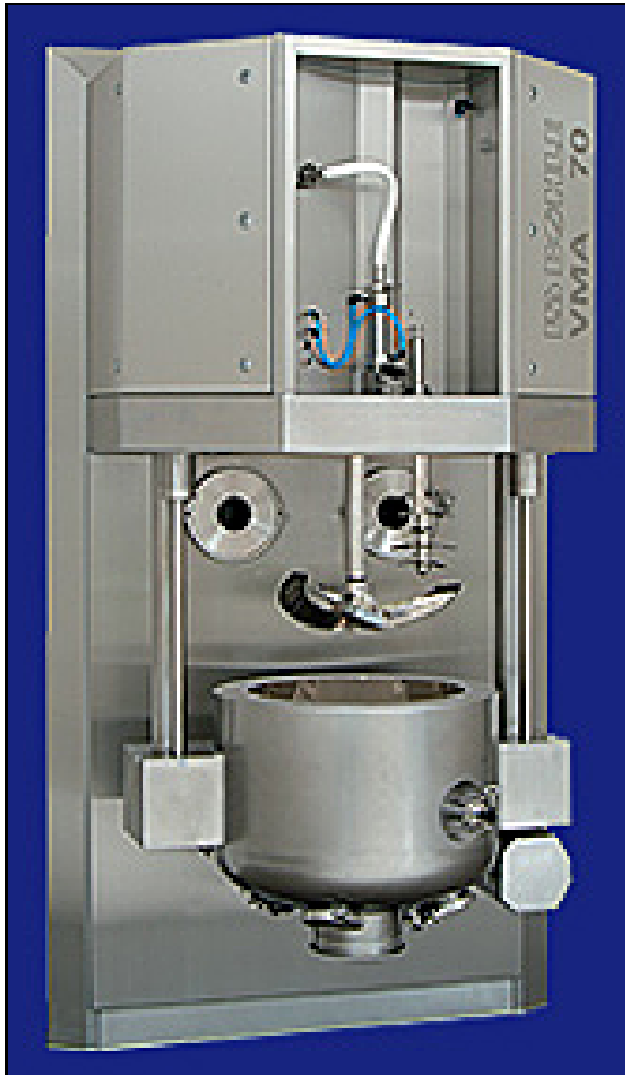
Abb. 3.2.2: Single-Pot-Granulator VMA 70 (links), schematischer Aufbau VMA70 (rechts)
