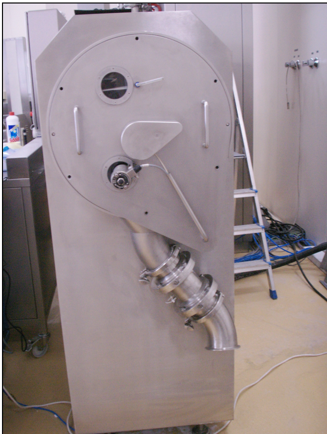
Abb. 6.3.8: Ausgang vom Vakuumtrockner
