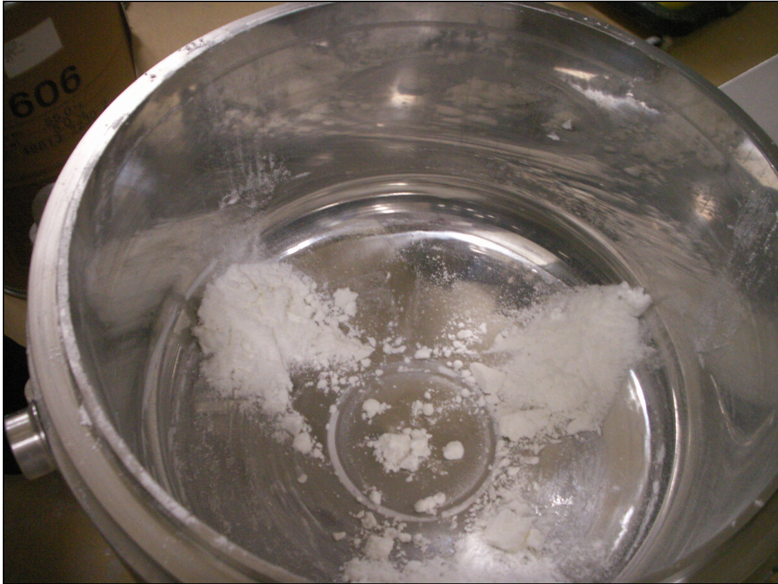
Abb. 6.3.3: Boden vom Granulator nach der Granulation
