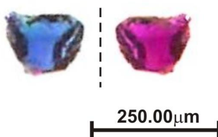
Abbildung 7.14 Kristallaufnahmen von \text{Li}_{5,88}\text{Co}_{5,08}(\text{P}_2\text{O}_7)_4 bei unterschiedlichen Polarisationsrichtungen des einfallenden Lichtes.
