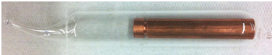
Abbildung 3.5 Evakuierte Ampulle aus Kieselglas mit Kupfer-Bömbchen.
