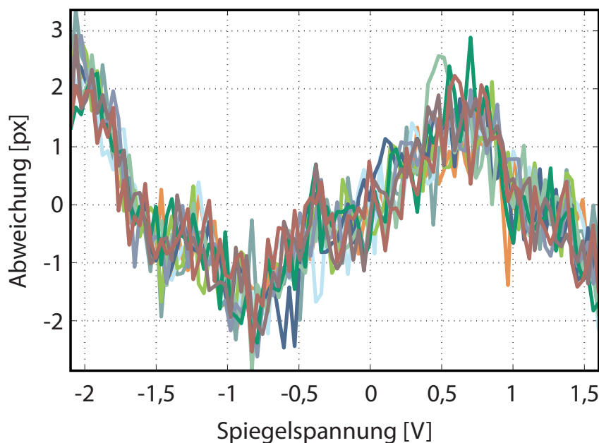
Abbildung 5.6: Überlagerung der Differenz von Strahlposition und angepasster Regressionsgerade von zehn Scankurven. Auffällig ist eine Oszillation der Strahlposition mit einer Amplitude von ca. 2 bis 3 Pixeln ( 1,3\ \mu\text{m} – 2\ \mu\text{m} ). \lambda_{exc} = 640\ \text{nm} , Pixelgröße 0,65\ \mu\text{m} . Jede Farbe steht für jeweils eine Messung.
