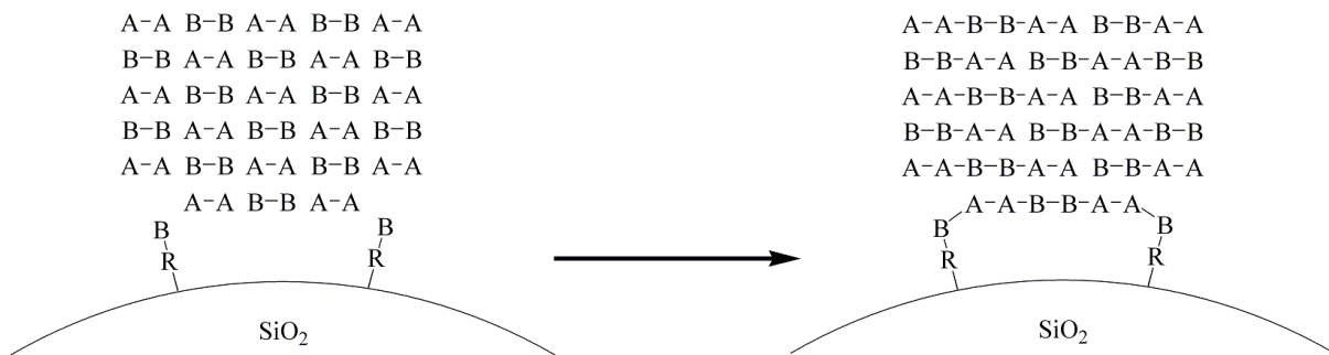
Abbildung 12.1.17: Schematische Darstellung des Verlaufs einer Stufenwachstumsreaktion in Gegenwart funktionalisierter SiO 2 -Partikel.
