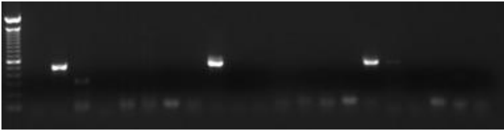
Abb. 9: Beispiel für eine Gelelektrophorese der Pools, die durch die generische nested PCR für Paramyxovirus (RMH) amplifiziert wurden; Banden im 100 bp Bereich sind vermutlich durch Primer-Dimere verursacht; Beispiel für eine Gelelektrophorese mit klaren Banden und damit ein Kandidat für die Sangersequenzierung
