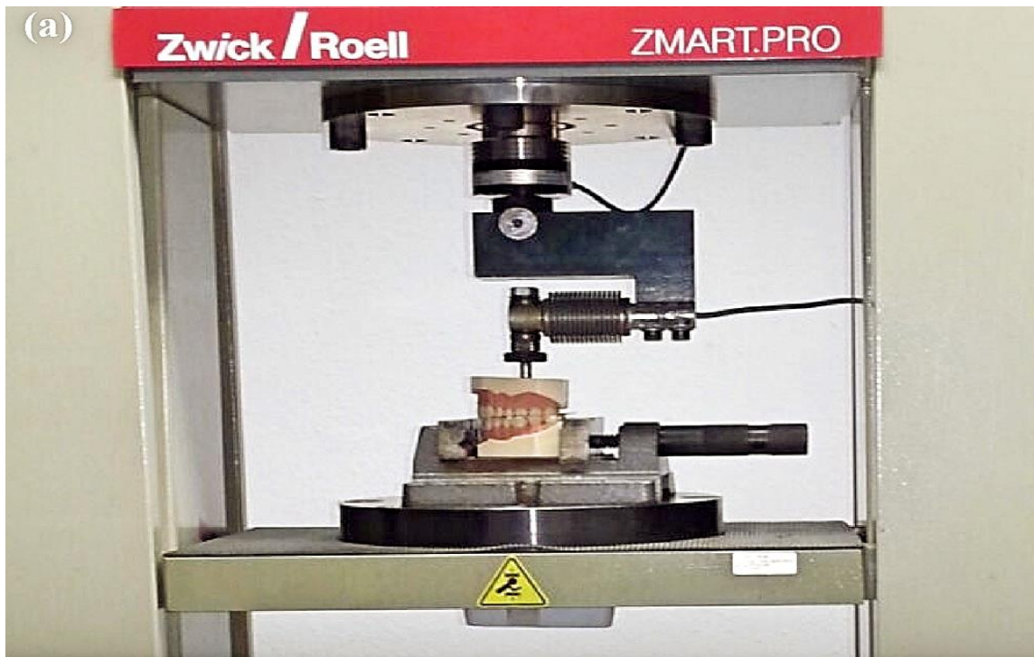
Abb. 6: Messapparatur zur Kalibrierung: die Folie befindet sich zwischen den Prothesenmodellen.
