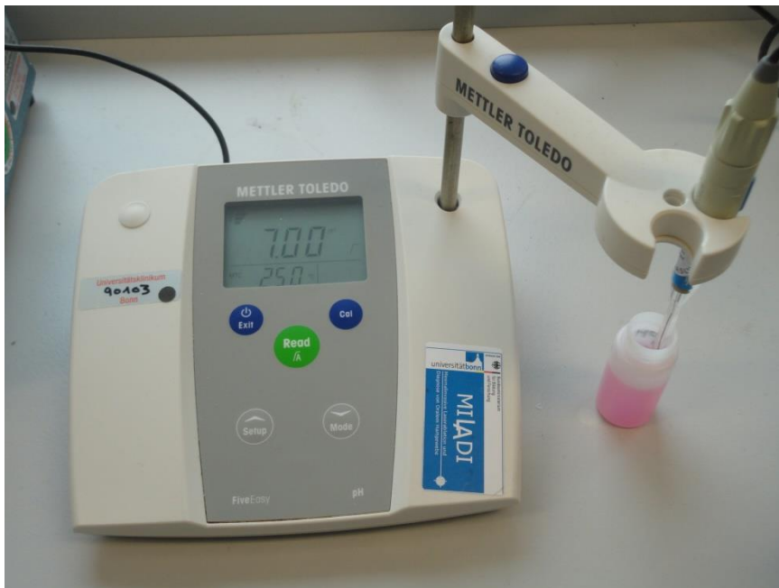
Abb. 8: pH-Elektrode Fa. Mettler Toledo, kalibriert auf pH 7,0 vor Anwendung in den Kulturröhrchen
