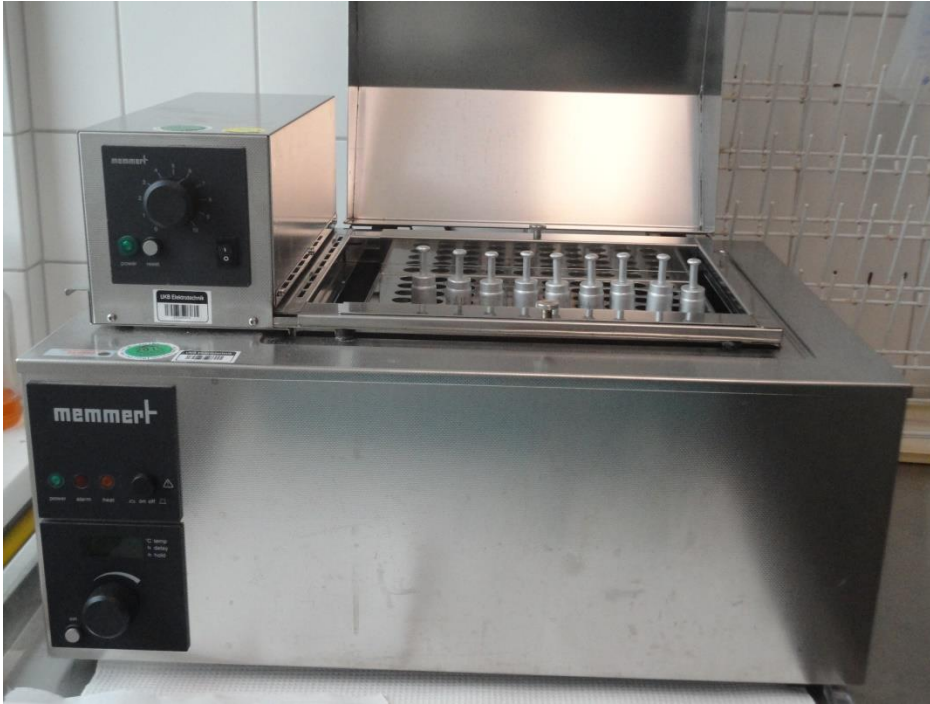
Abb. 6: Das für die Wachstumsversuche verwendete Schüttelwasserbad mit Kulturröhrchen, Fa. Memmert
