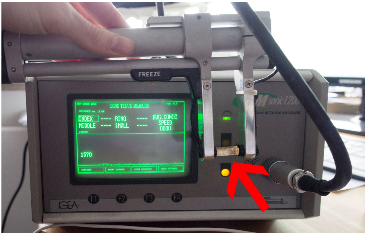
Abb. 6: DBM Sonic 1200 mit Knochenprobe zwischen den Schallköpfen (Pfeil)
