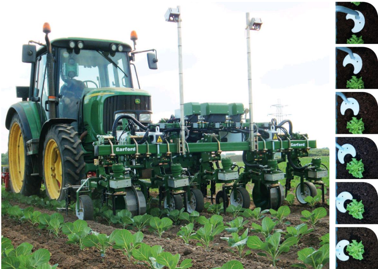
Bild 2.10: Kommerzielles Gerät für die Unkrautbekämpfung in der Reihe mit rotierenden Hackscheiben und Kameras für die Pflanzenerkennung (GARFORD 2011)
