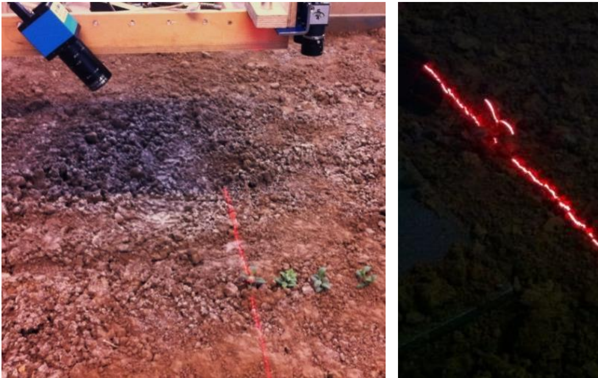
Bild 4.43: Aufbau für das Lichtschnittverfahren auf der Bodenrinne (links) mit der detaillierten, abgedunkelten Ansicht einer vom Linienlaser gekreuzten Pflanze (rechts)
