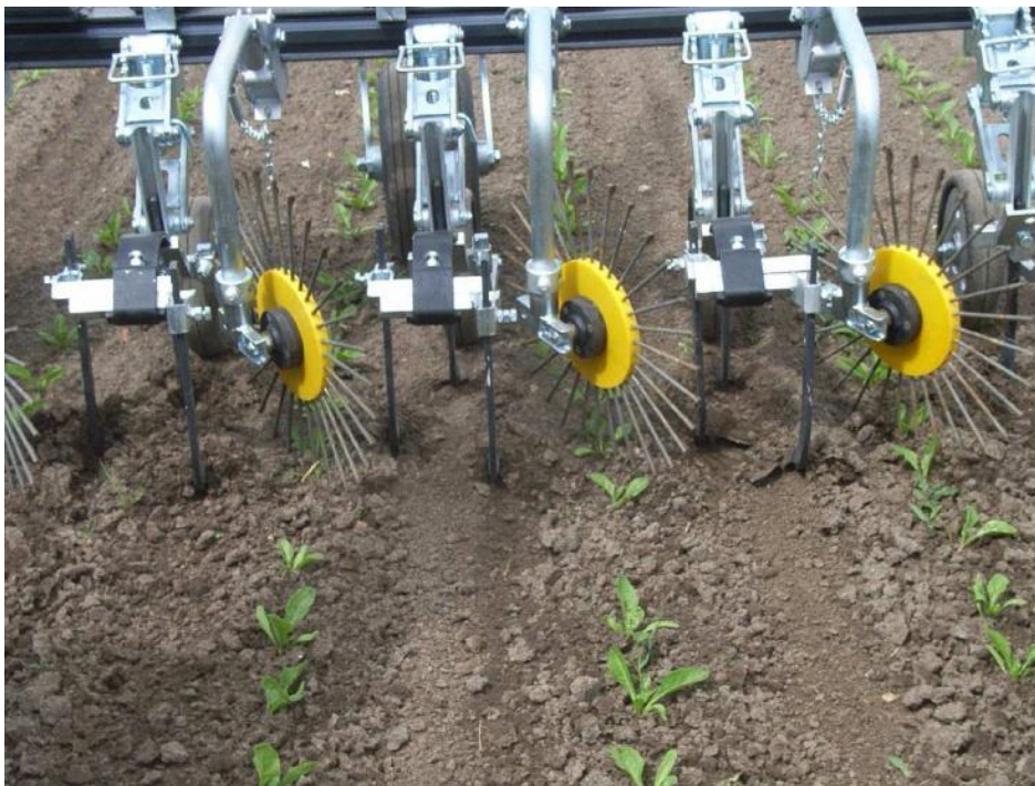
Bild 2.3: Rollstriegel in Zuckerrüben (MÜCKE 2012)
