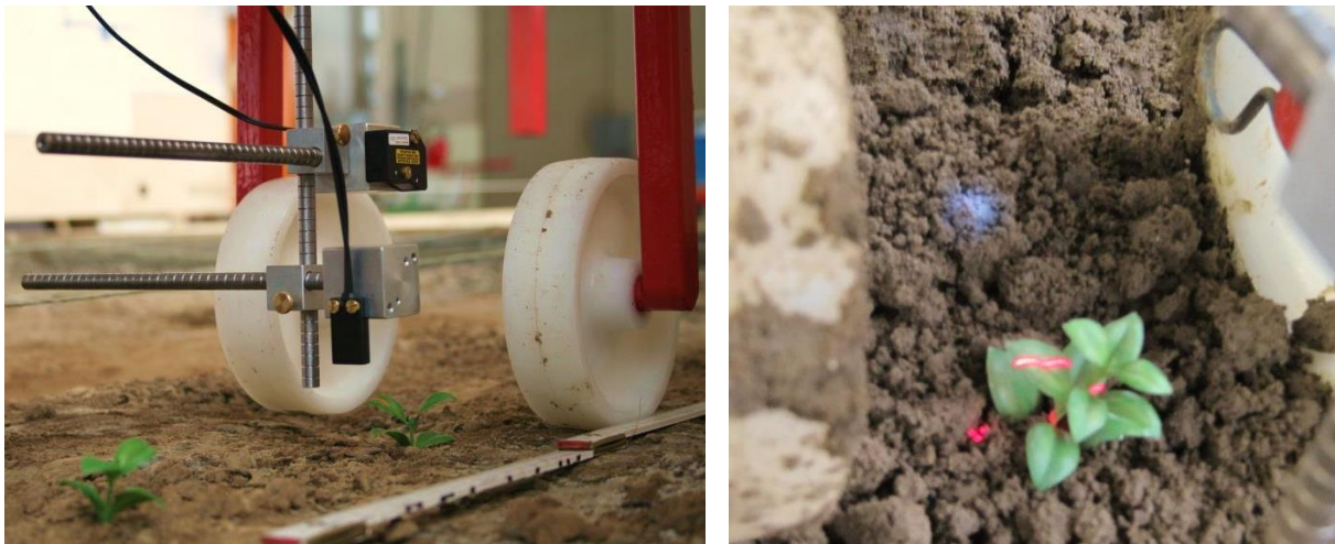
Bild 2.13: Sensorträger mit einem Farb- und Laser-Distanzsensoren zur Detektion der Pflanzen in der Reihe (links); Reflexionen des Farbsensors (blau) sowie des Laser-Distanzsensors (rot) (rechts)
