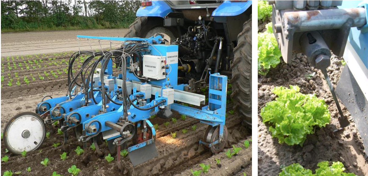
Bild 2.7: Hackgerät Robovator von F. Poulsen Engineering ApS für den Bereich zwischen und in den Reihen (links) mit einem sensorgesteuerten Werkzeug für den intra-row-Bereich (rechts) (POULSEN 2011)
