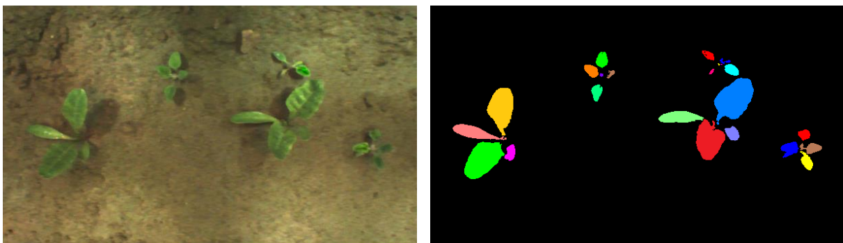
Bild 4.30: Original-Farbbild (links) und aus dem IR-Bild errechnetes Binärbild mit farblich markierten, gelabelten Blattflächen (rechts)
