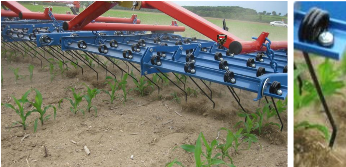
Bild 1.5: Hackstriegel bei der Unkrautbekämpfung im Mais (HATZENBICHLER 2014) (links); Federzinken eines Hackstriegels (rechts)
