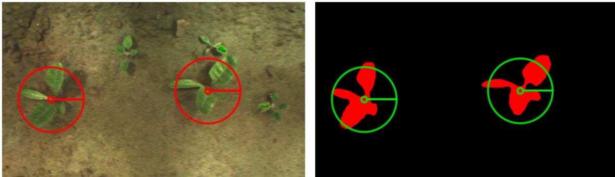
Bild 4.35: Originales Farb- (links) und Binärbild (rechts) mit den markierten Pflanzenmittelpunkten
