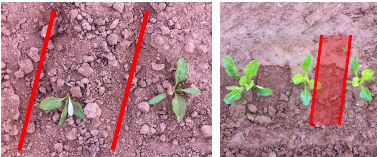
Bild 4.52: Kontrolle der Positionsgenauigkeit der Hackwerkzeuge mit einem Anreißer anstelle der Hackwerkzeuge (links: Spur des Anreißers rot markiert) sowie bei den Hackversuchen (rechts: gehackte Fläche rot markiert)
