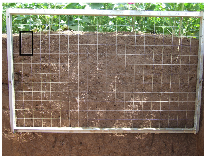
Abb. 4: Zählrahmen mit 5 × 5 cm-Gitter an einer fertig vorbereiteten Profilwand in Futtermalve. Versuch A, 06.07.2010. Für die statistische Analyse wurden Flächen zusammengefasst (beispielsweise in 10 cm-Schritten, siehe Rechteck).
