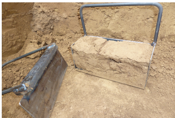
Abb. 5: Einfaches Stahlblech mit Schlagverstärkung (links) und Entnahmegewert aus geschärften Stahlblechen (rechts) mit der Abmessung 25 × 10 (× 10 cm).
