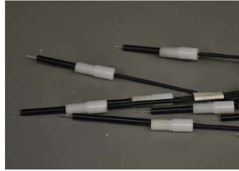
(b) Enden des Prototyp Lichtleiterbaums mit Befestigungsmechanik.
