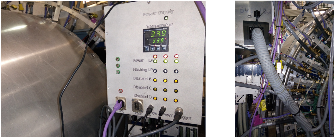
Abbildung 4.20: Links: Hier ist die Seite mit der Statusanzeige des Lichtpulsers gezeigt, installiert am Kalorimeter. Rechts: Die Fasern der einzelnen Kristalle laufen gebündelt (grau ummantelt) zur Lichtpulsersbox, in der sie an die LEDs angeschlossen sind.
