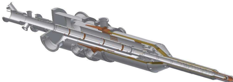
Abbildung 2.4: Dreidimensionale Repräsentation des Frozen-Spin-Targets, um Messungen mit polarisierten Nukleonen durchzuführen. Die Targetzelle befindet sich im vorderen Ende des Kryostaten (im Bild rechts) [Wal15].
