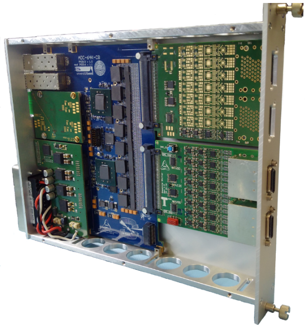
Abbildung 2.15: Prototyp des 64 Kanal-SADCs für das Crystal-Barrel-Kalorimeter [Mül17].
