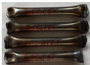
Abbildung 2.2.2: Durch Schweißen verschlossene Stahlampullen.
