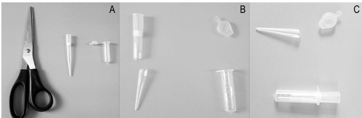
**Abb. 8:** Filterherstellung: A: Materialien zur Herstellung eines Filters: sterile 1000  $\mu\text{l}$  Pipettenspitze, 2 ml Reaktionsgefäß desinfizierte Schere. B: Die Pipettenspitze wird bei einer Länge von etwa 2 cm abgeschnitten und der Deckel des Reaktionsgefäßes entfernt. C: Die abgeschnittene Pipettenspitze wird in das Reaktionsgefäß eingesetzt.
