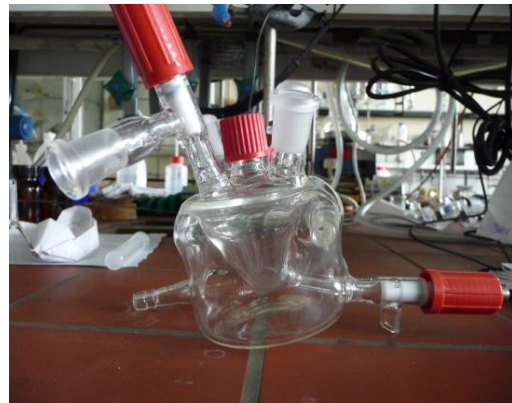
Abb. B-3: CV-Zelle mit Abgriff für Schutzgas und Kühlmantel
