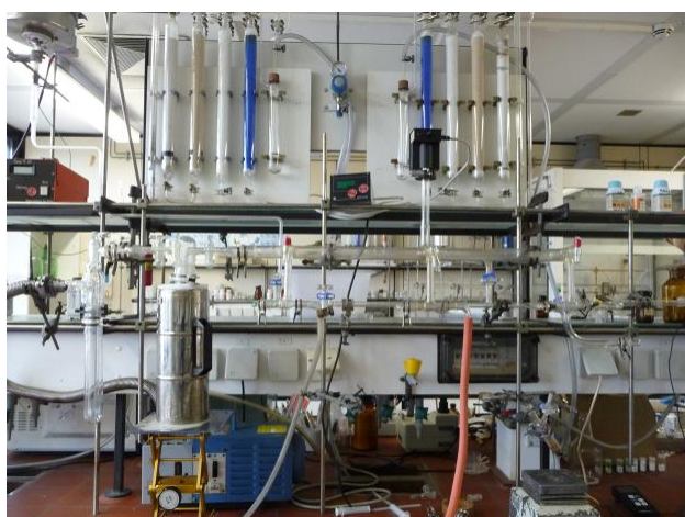
Abb. B-1: Aufbau der Schutzgas- und Vakuumapparatur mit Gasreinigung, Pumpe und Kühlfalle
