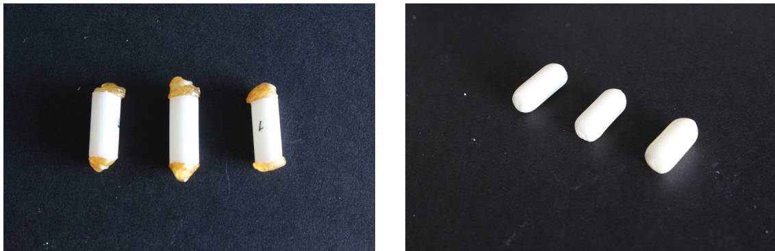
Abbildung 4.4.: Vergleich von zwei Methoden zum Verschließen der Hohlzylinder: geschmolzenes Polymer (links) und Heißluft (rechts)
