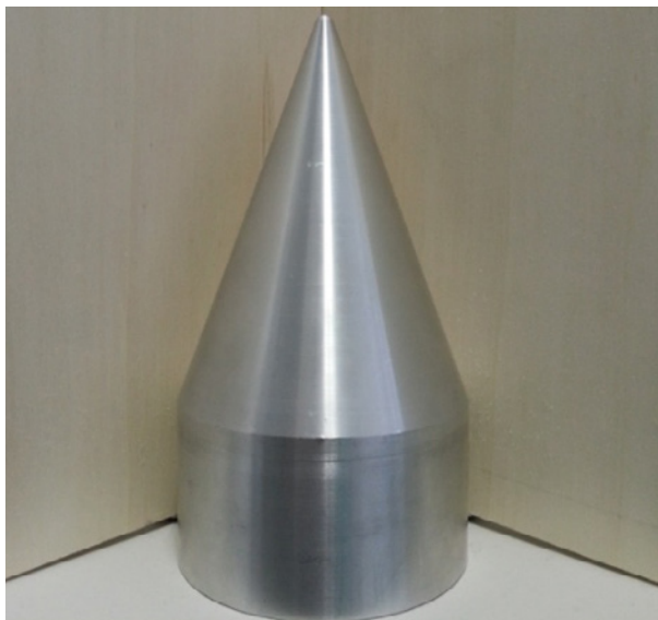
Abb. 9 | Mittels CNC-Fräse gefertigter Aluminiumkegel
