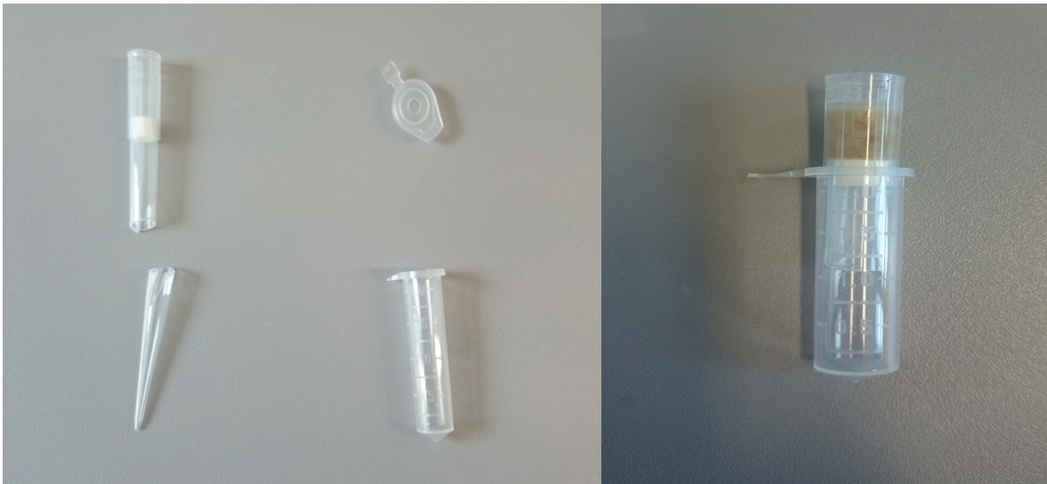
Abb. 1: Darstellung des angefertigten Filters. Links: Filterpipettenspitze und Probenröhrchen. Rechts: Zusammengesetzter Filter
