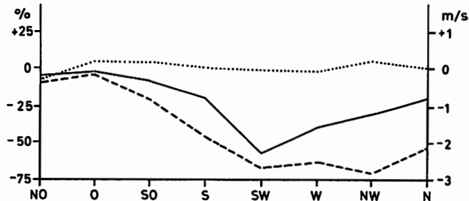
Abb. 19 Mittlere Änderung der Windgeschwindigkeit (m/s) und Windrichtung (%) an Pkt. 2 (vgl. Abb. 17) der Station Jollet gegenüber der Freilandwindgeschwindigkeit bzw. -richtung im Sommerhalbjahr (Apr.- Sept. 1976) in Abhängigkeit von der Windrichtung. Durchgezogene Linie: Änderung in m/s, unterbrochene Linie: prozentuale Änderung der Windgeschwindigkeit, punktierte Linie: Änderung des prozentualen Anteils der Einzelrichtung (vgl. auch Abb. 12-14 und Karte 20).
