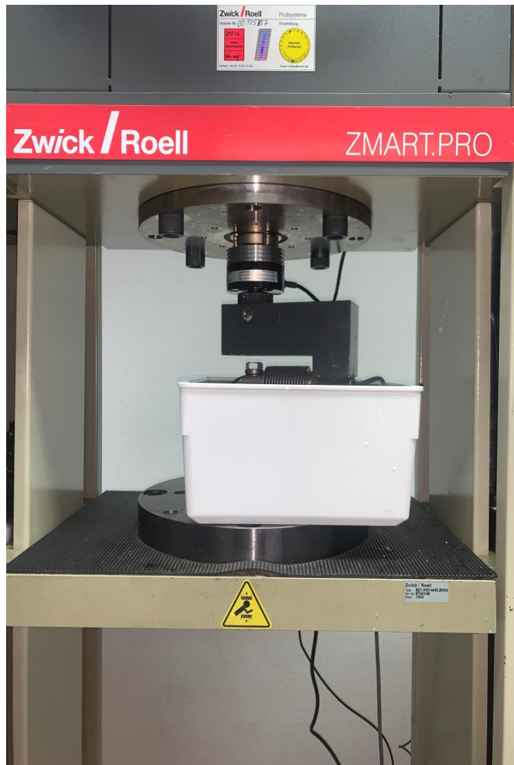
Abb 15: Übersichtsaufnahme der Prüfmaschine für den zweiten Versuchsdaufbau. Die Relaxationsmessungen wurden an der ZMART.PRO® (Firma ZwickRoell) durchgeführt.
