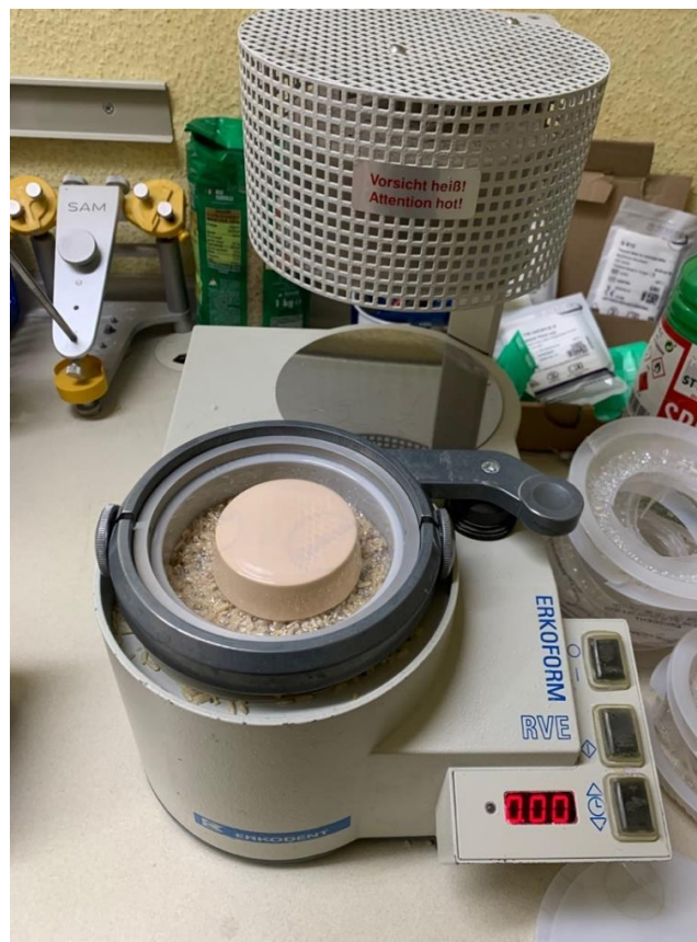
Abb. 11: Vakuumtiefziehgerät „Erkoform-RVE“ der Firma Erkodent (Erich Kopp GmbH, Pfalzgrafenweiler, Deutschland) mit Zylinder aus Gips und verarbeiteter Folie gleich nach dem Tiefziehvorgang.
