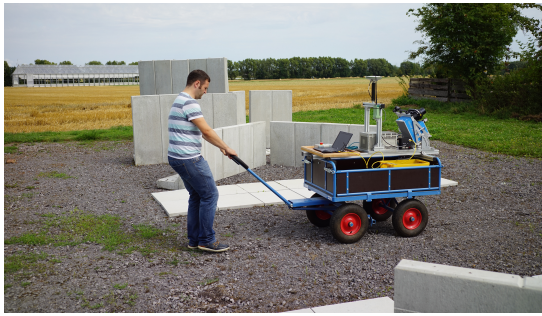
Abbildung 5.18: Kalibrierdurchlauf im ebenenbasierten Kalibrierfeld mit dem Mobile Mapping System.
