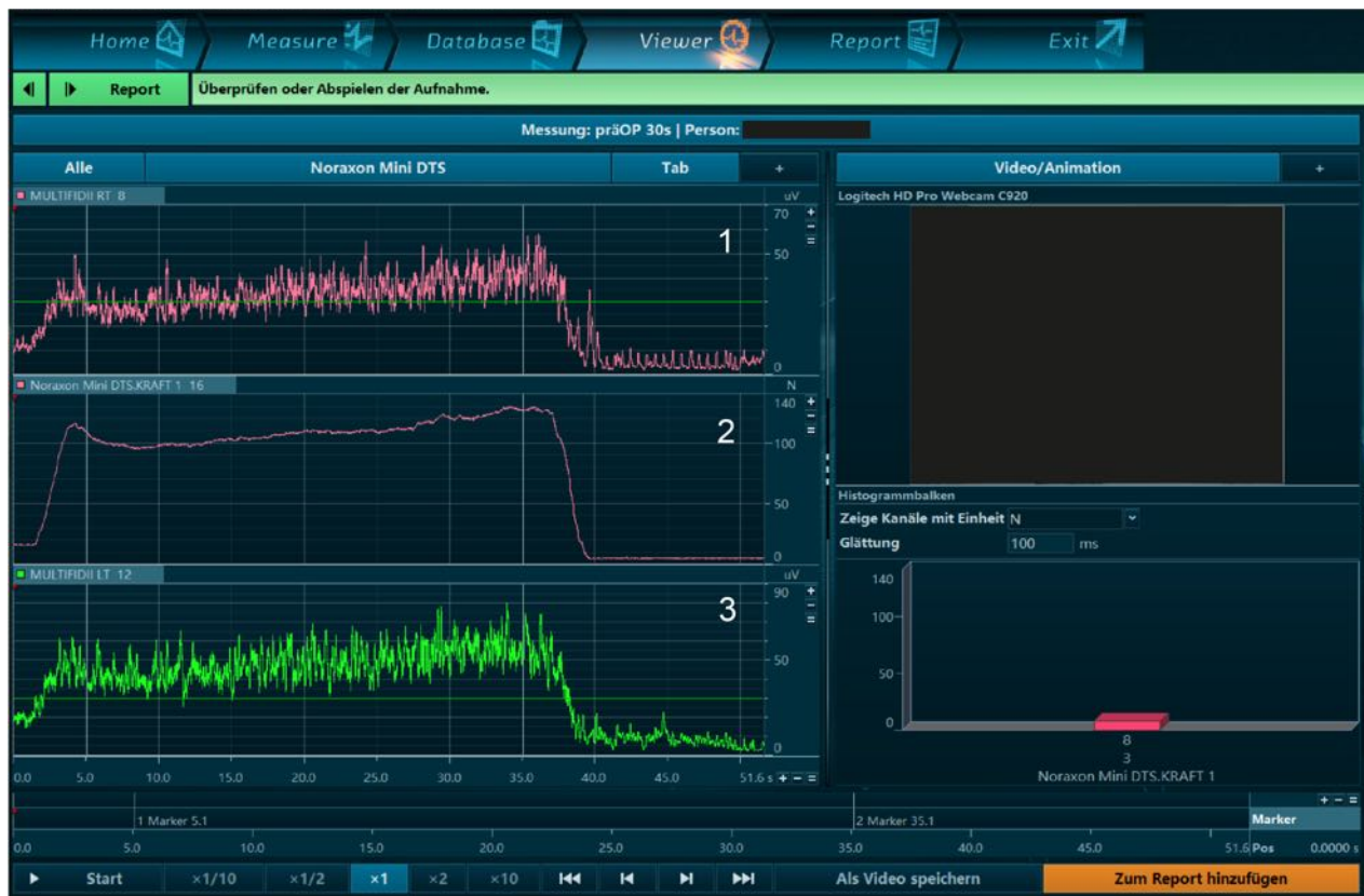
Abb. 19: Beispielhafter Screenshot einer EMG-Messung der submaximalen Kontraktion aus MyoResearch 3: (1) EMG-Signal rechter M. multifidus, (2) 50 %-ige Kraft aus vorausgegangener MVC-Messung, (3) EMG-Signal linker M. multifidus, (graue vertikale Linien) digitale Marker für den 30-sekündigen Analysezeitraum.
