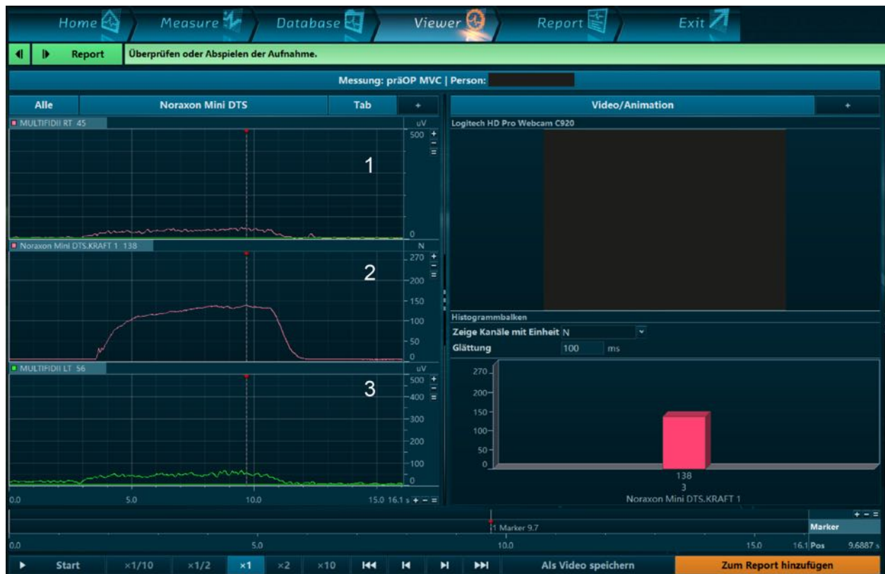
Abb. 17: Beispielhafter Screenshot der konvertierten (RMS-EMG) MVC Messung aus MyoResearch 3: (1) Amplitude rechter M. multifidus, (2) Muskelkraft, (3) Amplitude linker M. multifidus, (rote Pfeilspitze) digitaler Marker des Analysezeitraums.
