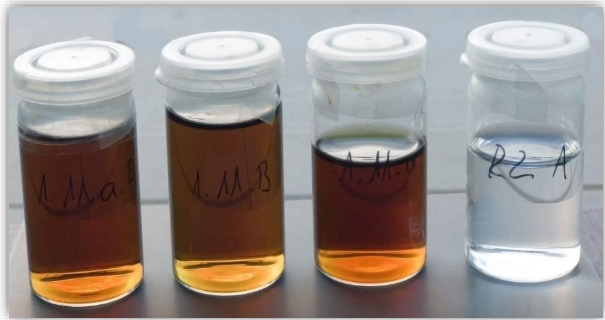
Abb. 13: Korrosionslösung der Kombinationen ECONOLINE™, TMA-Bögen und Stahlligaturen (links) im Vergleich mit ihrer Referenz (rechts).
