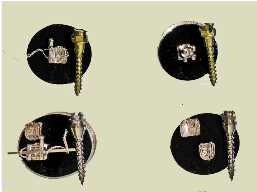
Abb. 12: Die Oberflächen ausgewählter Proben wurden sowohl vor als auch nach Korrosion im REM begutachtet. Man sieht auf den nummerierten REM-Probenträgern Brackets, Bögen, Stahllegierungen und Verankerungsschrauben.
