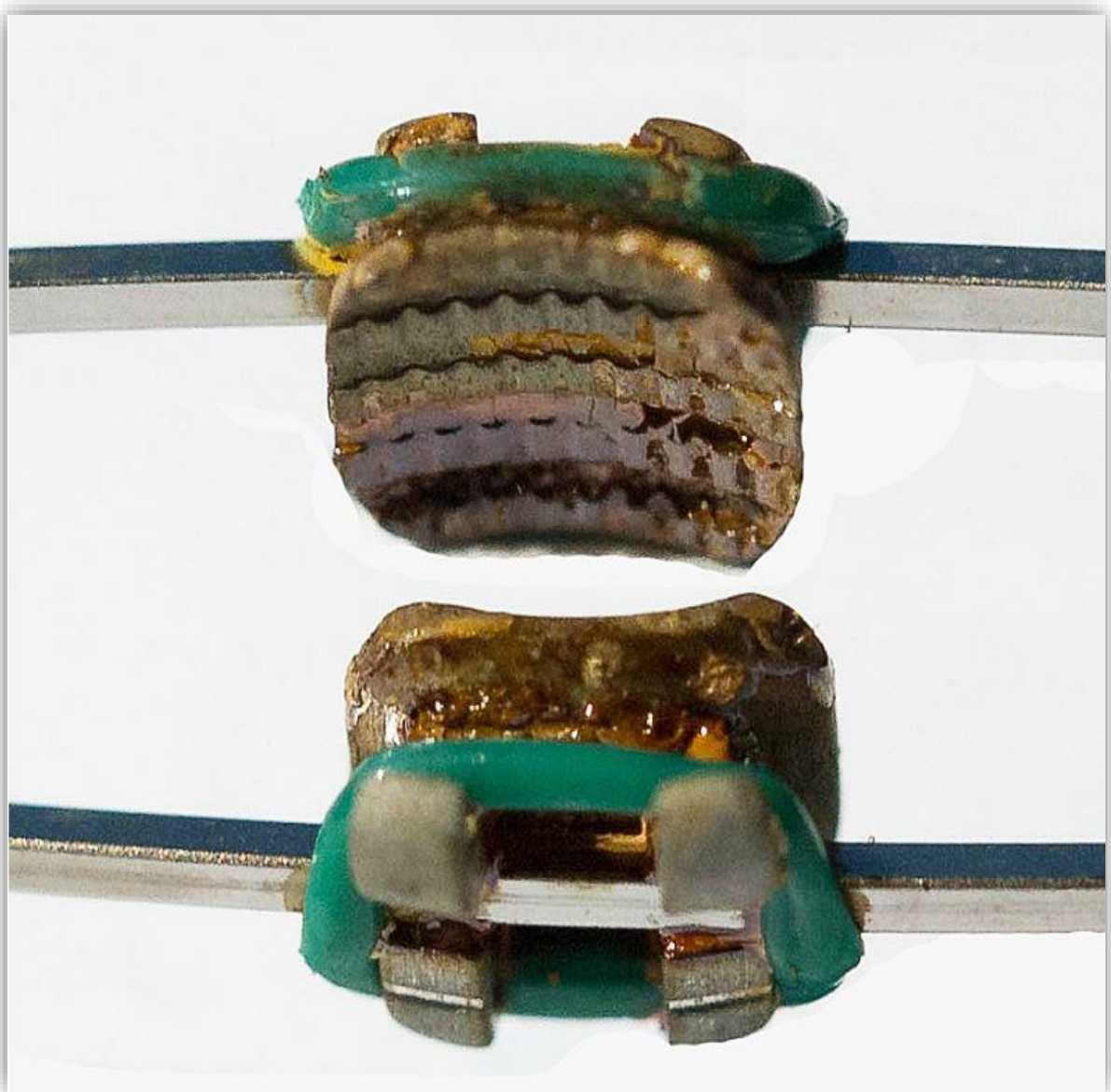
Abb.19: Rotbraune Ablagerungen auf den Oberflächen der Kombination ECONOLINE™, TMA-Bogen und Alastic.
