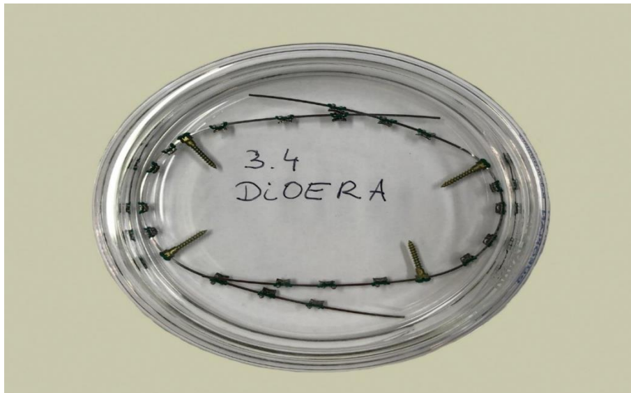
Abb. 8: Versuchsaufbau: Petrischale bestückt mit Brackets, einligierten Bögen, Verankerungsschrauben und der Milchsäurelösung.
