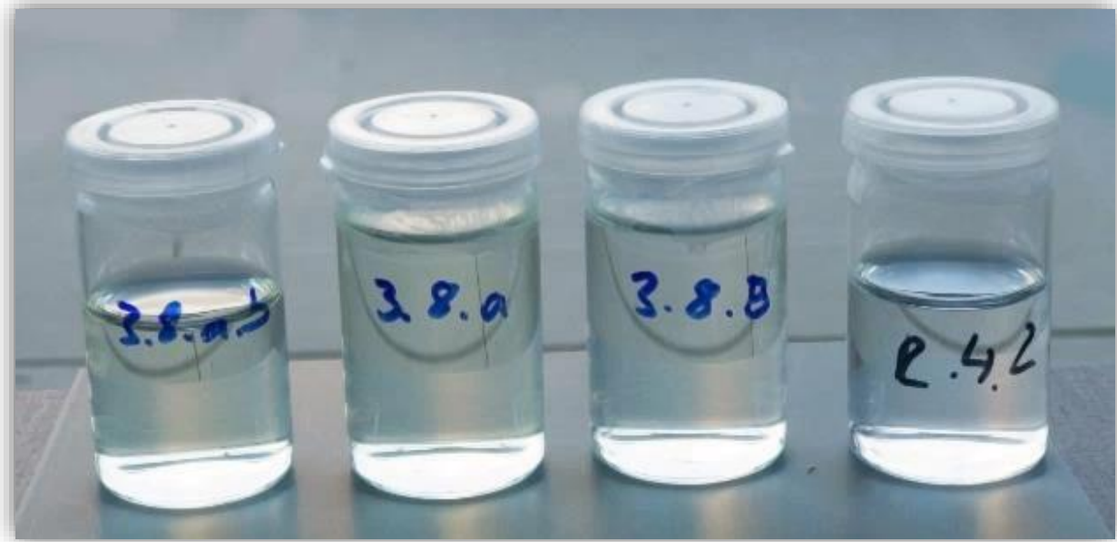
Abb. 16: Korrosionslösungen der Kombination discovery® smart-Brackets, Remanium®-Bögen, Alastics und Orthodontic Implant (links) im Vergleich mit ihrer Referenz (rechts).
