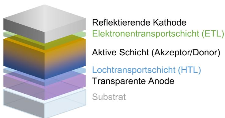
Abb. 2-35: Schematische (nicht maßstabgetreue) Veranschaulichung der Schichtfolge einer konventionellen organischen Photodiode mit Elektronen- und Lochtransportschichten.
