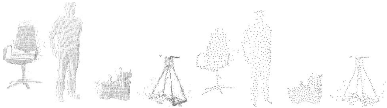
Abbildung 4.19: Links: 3D-Modelle (Punktwolken) der Datenbasis. Rechts: Reduzierte Modelle mit je 250 3D-Punkten.
