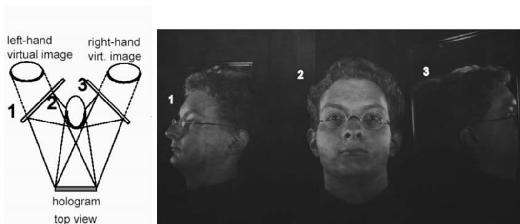
Abbildung 3.37: Virtuelles Bild eines Portraithologramms, wobei die Seitenansichten mit zwei Spiegeln erfasst wurden. Quelle: [94].
