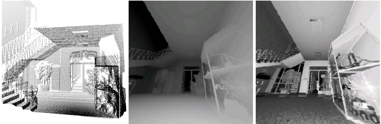
Abbildung 4.11: Links: 3D-Scan als Punktwolke. Mitte: 3D-Szene als Tiefenbild, wobei dunkle Grautöne größeren Entfernungen entsprechen. Rechts: Reflektionsbild der Szene.
