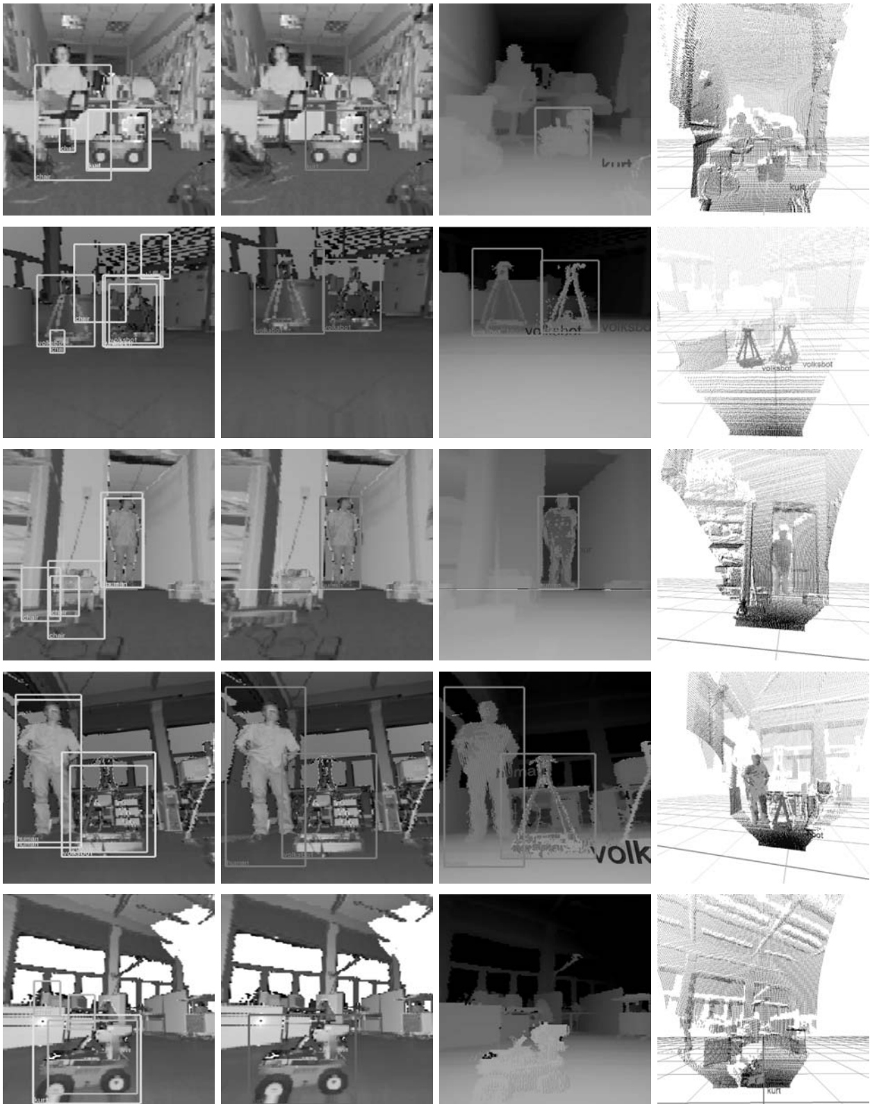
Abbildung 4.21: Objektdetektion und -lokalisierung. Von links nach rechts pro Zeile: (1) Detektion mit Hilfe einer einzelnen Kaskade von Klassifikatoren. Hellgrau: Detektion im Reflektionsbild. Grau: Detektion im Tiefenbild. (2) Detektion mit der kombinierten Reflektions- und Tiefenbildkaskade. (3) In das Tiefenbild wurde das 3D-Modell (hellgrau) eingezeichnet. (4) Darstellung der lokalisierten Objekte in den 3D-Scandaten.
