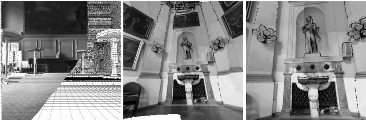
Abbildung D.2: Links: Schematische Darstellung des Texturierens von 3D-Szenen. Mitte und rechts: 3D-Szene mit Texturen aus zwei verschiedenen Posen betrachtet.
