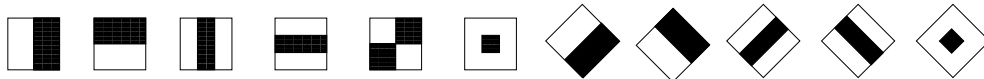
Abbildung 4.12: Merkmale zur Objekterkennung. Kanten-, Linien-, Diagonal-, und center-surround Merkmale. Die invertierten Merkmale können durch Einstellung des Schwellwertes in den Merkmalen entstehen.
