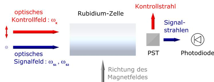
**Abbildung 5.6:** Schema des experimentellen Aufbaus. Die Polarisation des Kontrollfeldes mit der Frequenz  $\omega_K$  ist orthogonal zur Polarisation der Signalfelder mit den Frequenzen  $\omega_{S1}$  und  $\omega_{S2}$ . Die Kontroll- und Signalfelder werden vor dem Eintritt in die Rubidium-Zelle räumlich überlagert.
