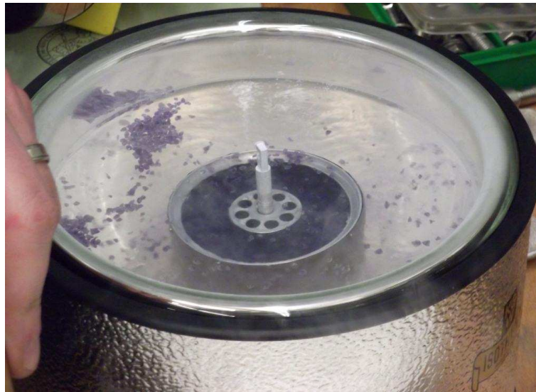
Abbildung 6.2.3: Foto des bestrahlten Ammoniaks. Zu sehen ist der Bestrahlungskontainer in einem Bad aus flüssigem Stickstoff. Die violetten Granulate sind das bestrahlte Ammoniak.
