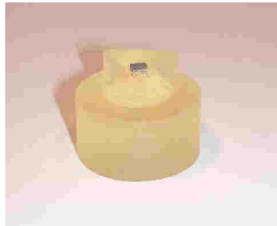
Abbildung 13: In Kunststoff (Technovit 4004) eingebettetes Bracket. Die Bracketbasis wurde vorher mit Wasser abgedampft und mit ölfreier Pressluft getrocknet.
