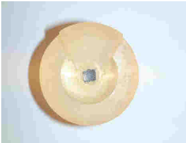
Abbildung 13: In Kunststoff (Technovit 4004) eingebettetes Bracket. Die Bracketbasis wurde vorher mit Wasser abgedampft und mit ölfreier Pressluft getrocknet.
