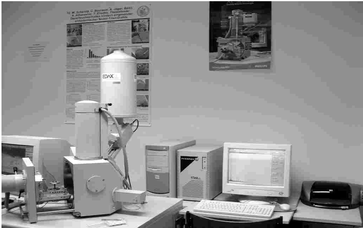
Abbildung 8: Das Rasterelektronenmikroskop Philips XL 30 mit Steuer-PC und EDX Anlage, das zur Anfertigung der REM-Bilder benutzt wurde.
