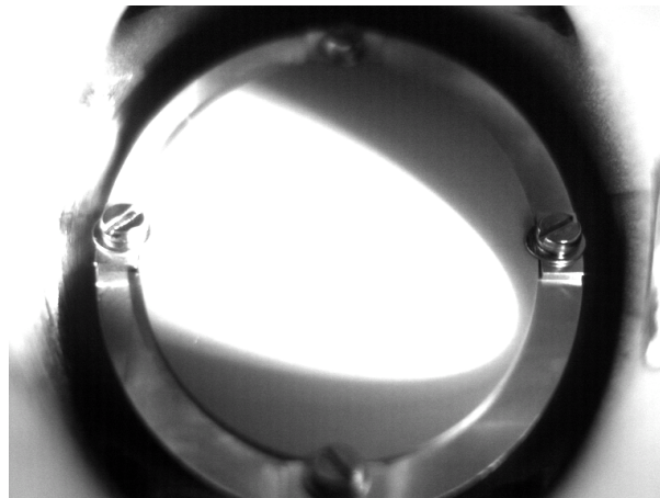
Abbildung 7.8: Bild des beleuchteten Strahlschirms S2. Die elliptische Chromox -Scheibe ist mittels Schrauben mit Unterlegscheiben auf der Halterung (siehe Abbildung 5.10(b)) befestigt. Der Schirm wird mit einer Leuchtdiode beleuchtet. Es ist zu erkennen, dass das Bild aufgrund einer engen Schärfentiefe nur im Bereich der Schirmmitte scharf ist. Eine weite Schärfentiefe wäre mit einer größeren Blendenzahl – einer kleineren Blendenöffnung – erreichbar, jedoch wird das Abbild des Strahls wegen dessen geringer Intensität dann nicht mehr von der Kamera erfasst.
